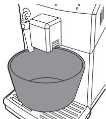
**6** Appuyez sur le bouton CALC CLEAN en le maintenant enfoncé pendant 3 secondes pour lancer le cycle de détartrage. Le voyant du bouton ESPRESSO reste allumé et le voyant du bouton CALC CLEAN clignote tout au long du cycle.
