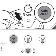
**7** Le voyant du cycle de détartrage reste allumé. La machine commence à verser la solution de détartrage par intervalles pendant environ 20 minutes.
