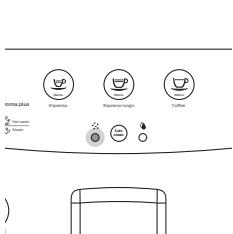
**8** Laissez la machine verser la solution de détartrage jusqu'à ce que le voyant « Réservoir d'eau vide » reste allumé.
