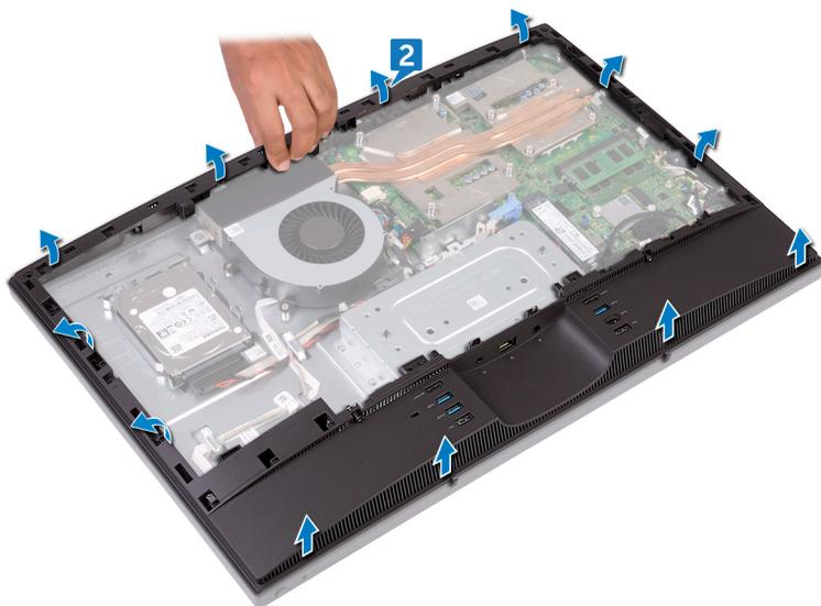
**3** Heben Sie den inneren Rahmen aus dem mittleren Rahmen heraus.
