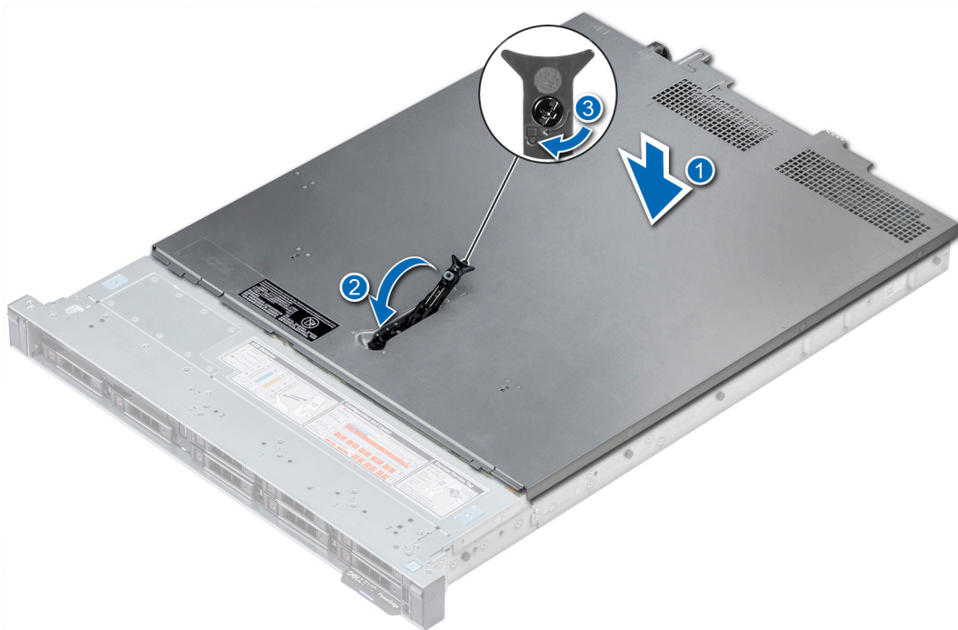
Abbildung 20. Installieren der Systemabdeckung
