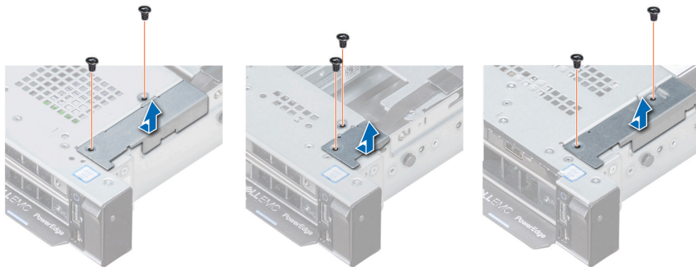
Abbildung 108. Entfernen der Kabelabdeckung
