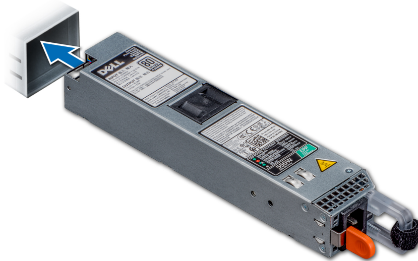
Abbildung 100. Installieren einer Netzteilereinheit
