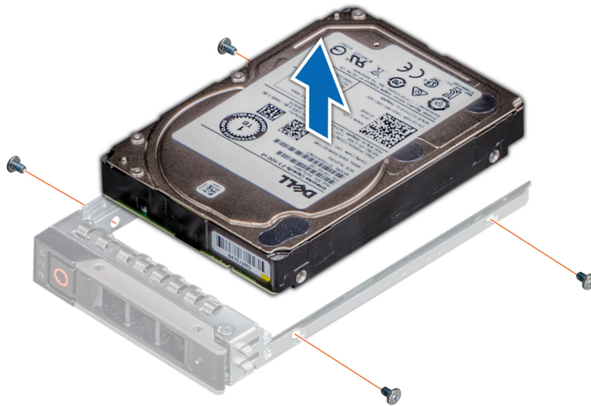
Abbildung 38. Entfernen des Laufwerks aus dem Laufwerksträger
