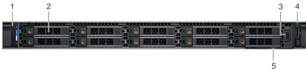
Abbildung 3. Frontansicht eines Systems mit 10 x 2,5-Zoll-Laufwerken
