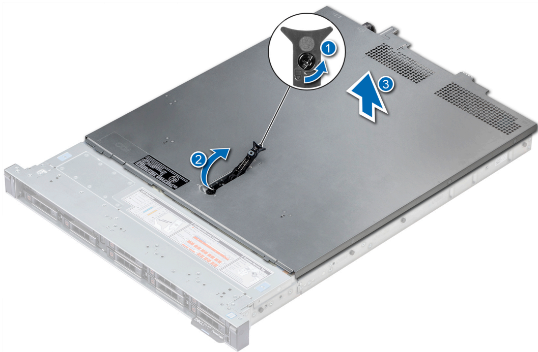
Abbildung 19. Entfernen der Systemabdeckung
