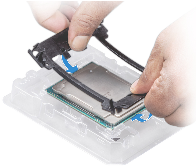
Abbildung 46. Installieren der Prozessor-Halterung
