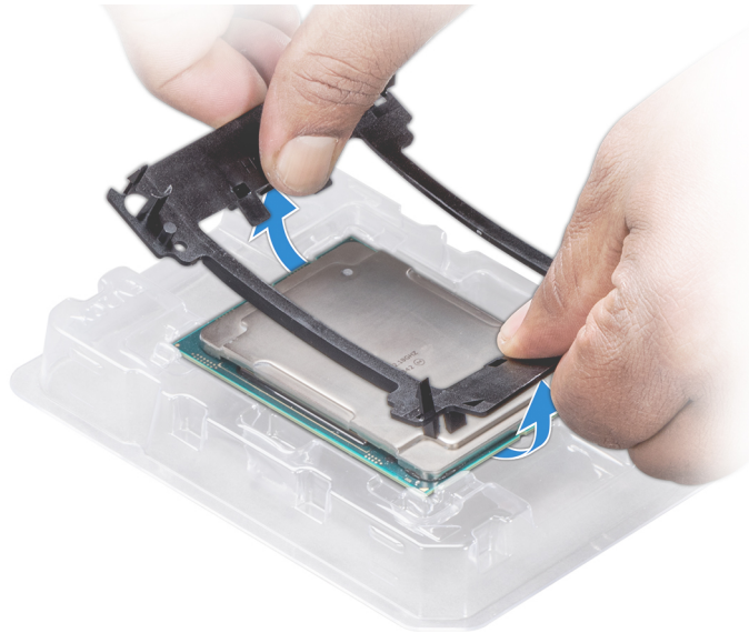
Abbildung 45. Entfernen der Prozessorhalterung
