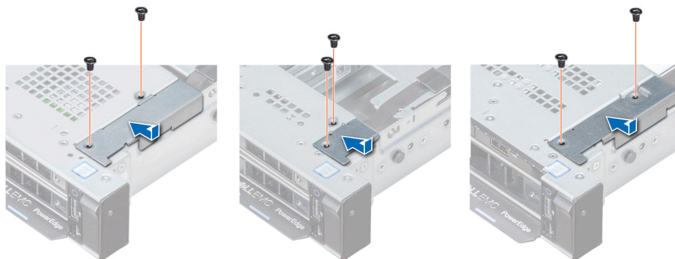
Abbildung 110. Installieren der Kabelabdeckung
