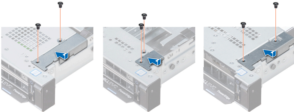
Abbildung 108. Installieren der Kabelabdeckung
