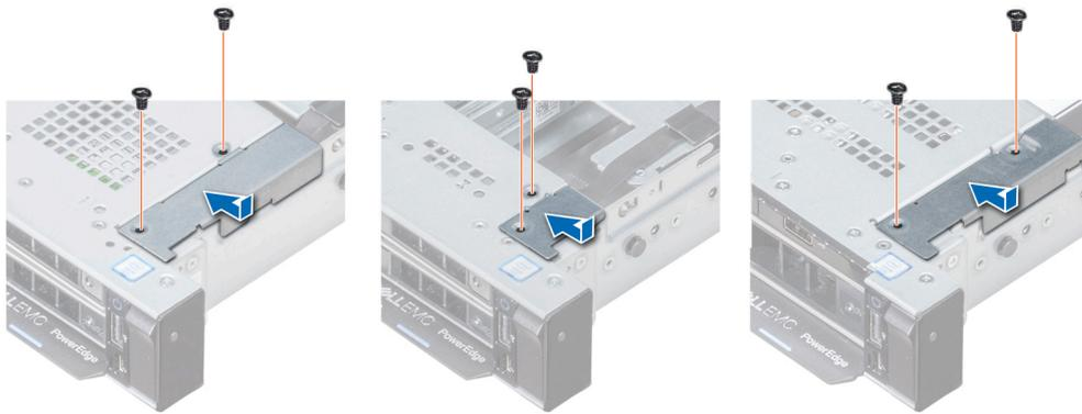
Figure 108. Installation du cache-câbles
