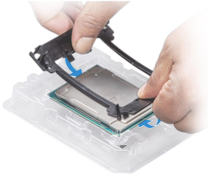
**Figure 46. Installation du support de processeur**
