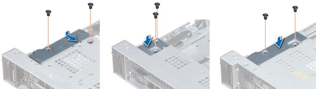
**Figure 105. Installation du cache-câbles**
