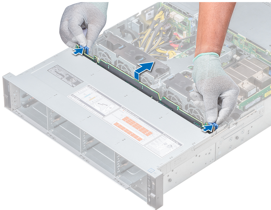
Abbildung 99. Entfernen der Rückwandplatine
