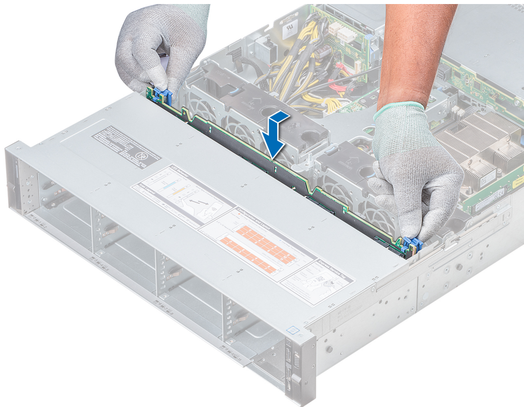
Abbildung 100. Installieren der Rückwandplatine
