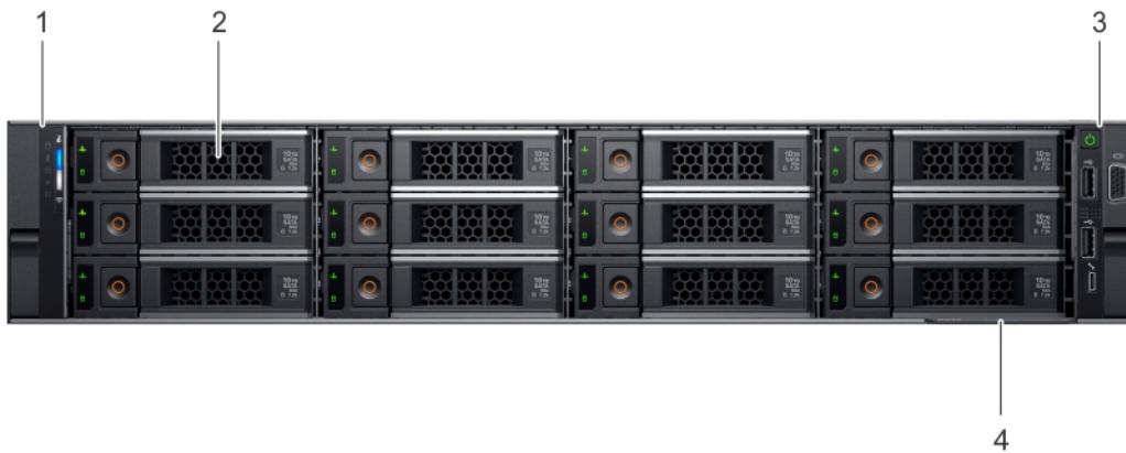
Abbildung 2. Frontansicht eines Systems mit 12 x 3,5-Zoll-Laufwerken
