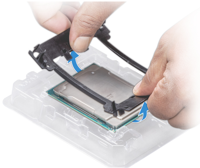
Abbildung 60. Entfernen der Prozessorhalterung
