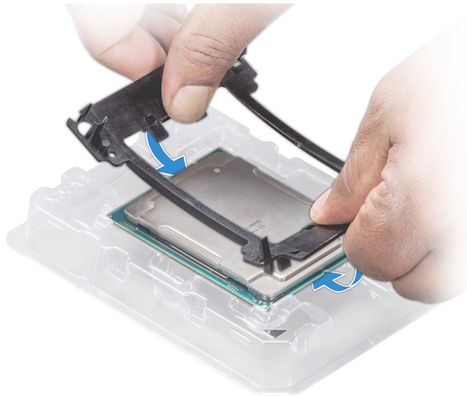
Abbildung 61. Installieren der Prozessor-Halterung
