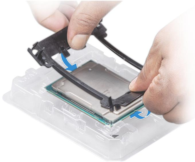
**Figure 61. Installation du support de processeur**
