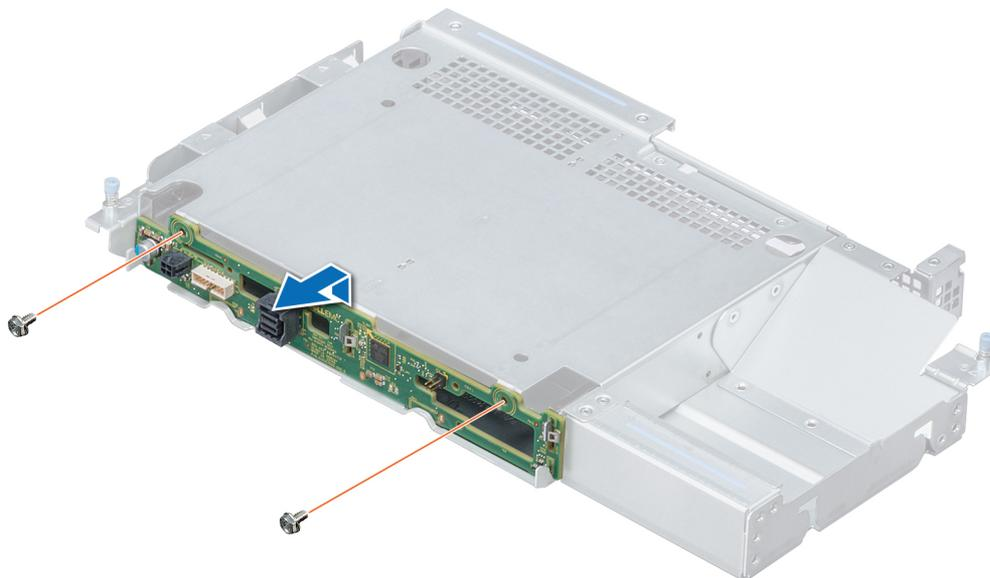
Figure 101. Retrait du backplane de disque arrière de 3,5 pouces
