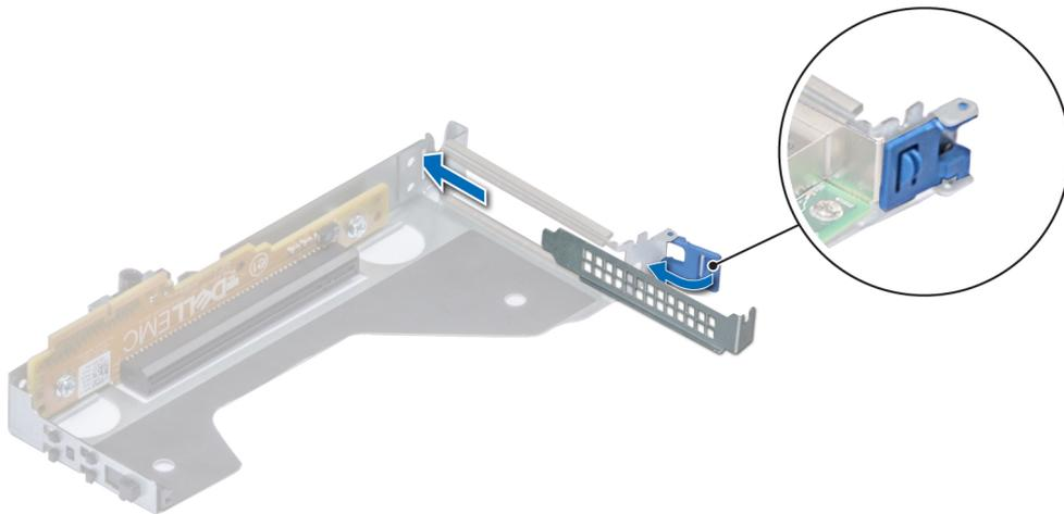
**Figure 68. Installation d'une plaque de recouvrement pour la carte de montage mi-hauteur**
