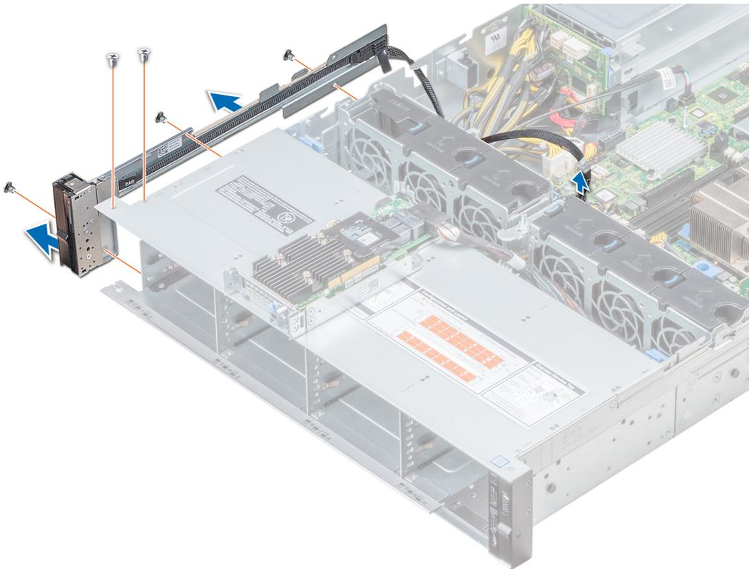
**Figure 121. Retrait du panneau de commande de gauche**
