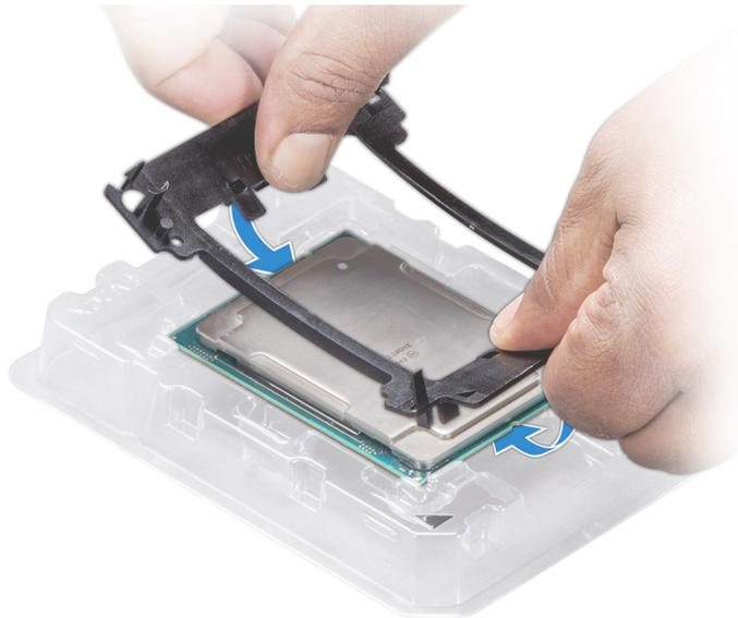
Figure 61. Installation du support de processeur
