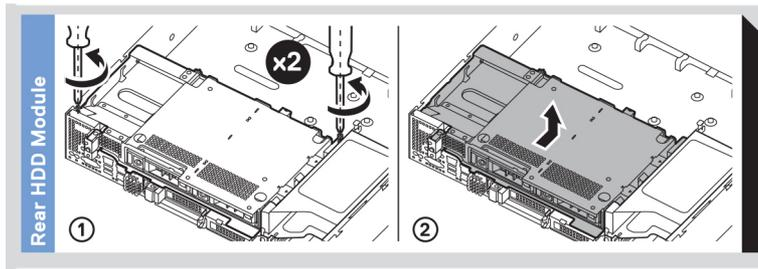
Figure 21. Installation du disque arrière
