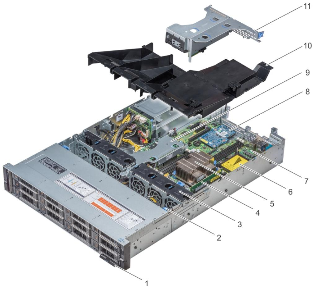
Figure 29. Intérieur du système sans bâti de disques arrière
