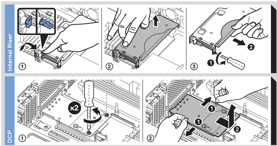
Figure 19. Installation de l'adaptateur OCP et de la carte de montage PERC interne
