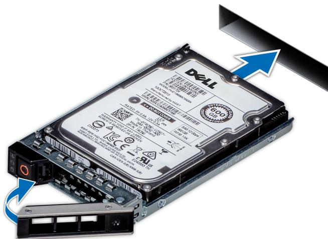
Figure 52. Installation d'un support de disque
