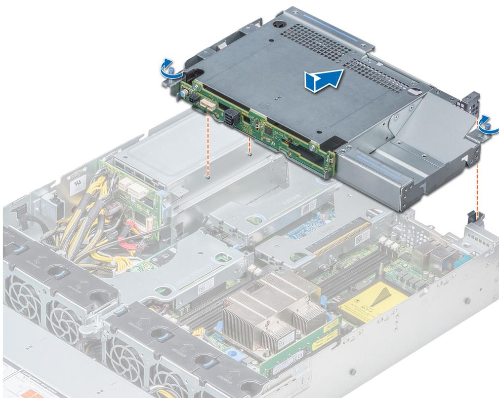
Figure 108. Installation du bâti des disques arrière
