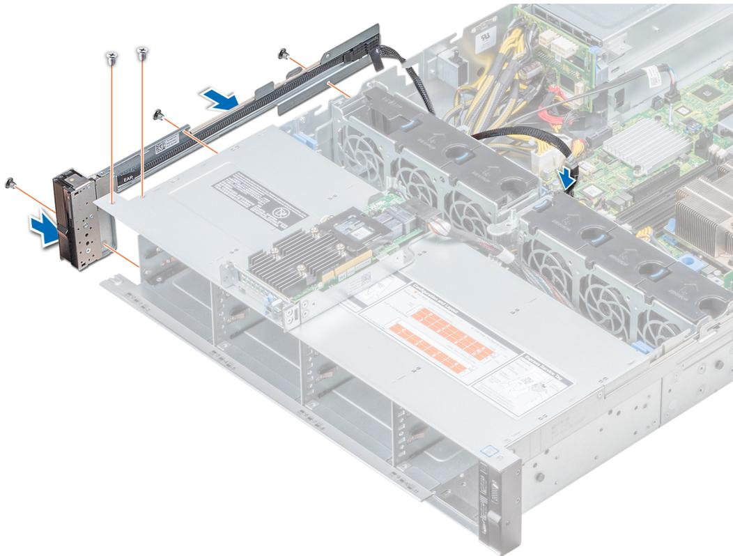
Figure 122. Installation du panneau de commande gauche
