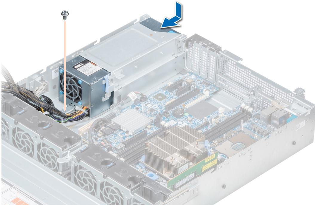
Figure 118. Installation d'un bloc d'alimentation en CA câblé non redondant
