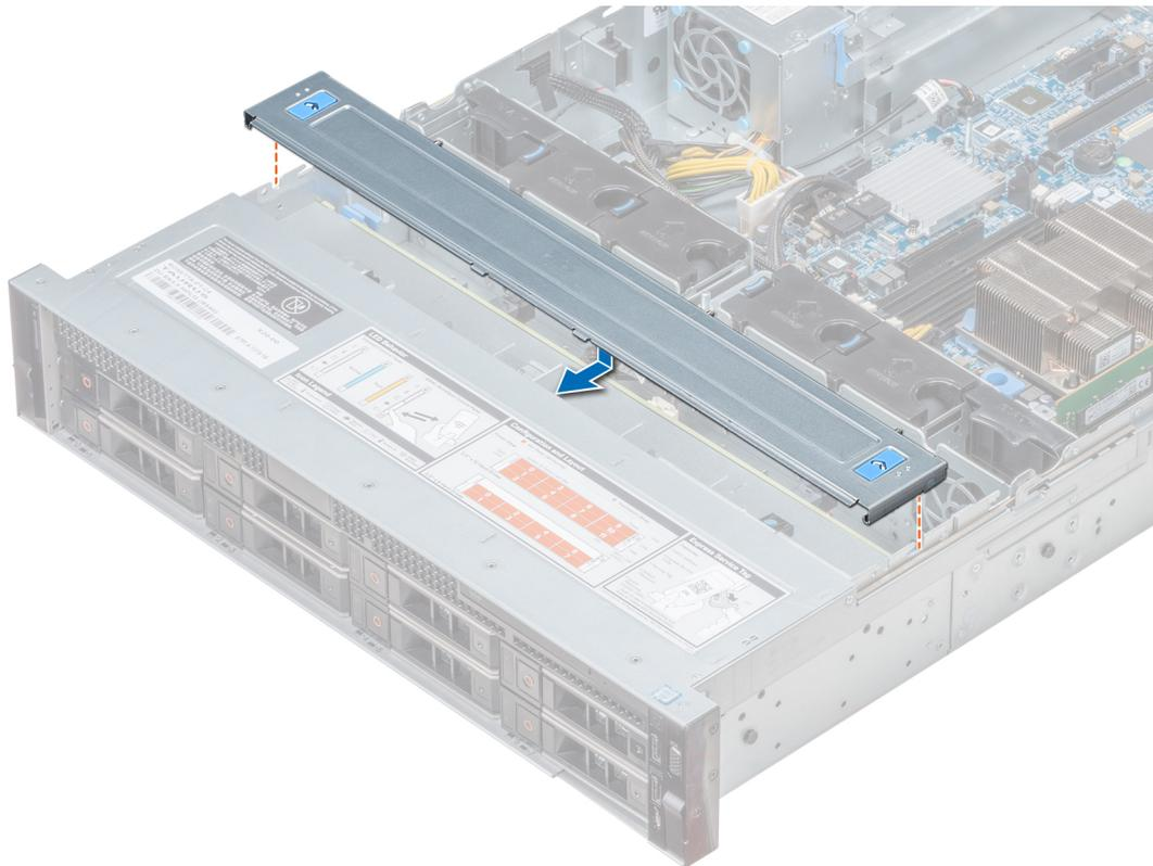
Figure 28. Installation du cache de fond de panier
