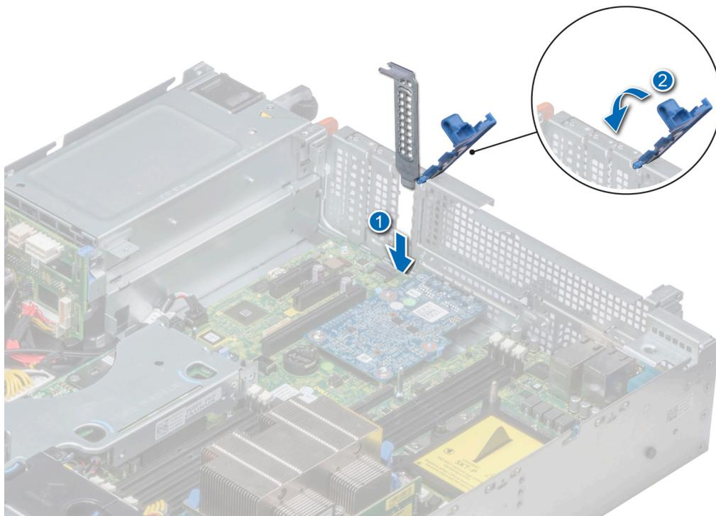
Figure 78. Installation de la plaque de recouvrement
