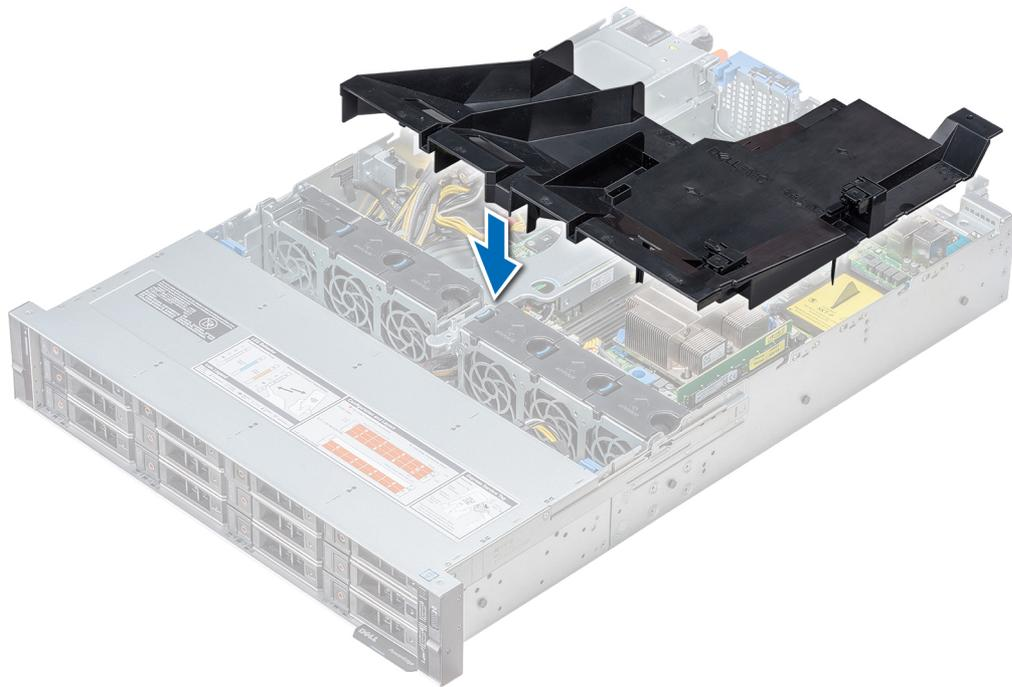
Figure 32. Installation du carénage d'aération
