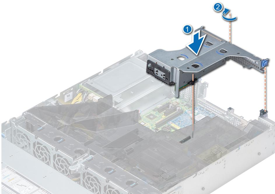
Figure 88. Installation de la carte de montage papillon
