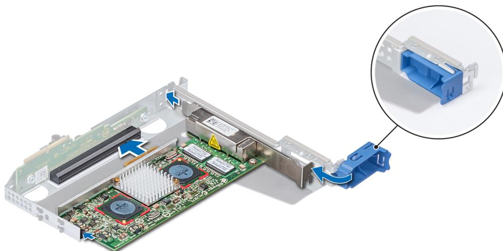
**Figure 75. Installation d'une carte d'extension dans la carte de montage pleine hauteur X1**
