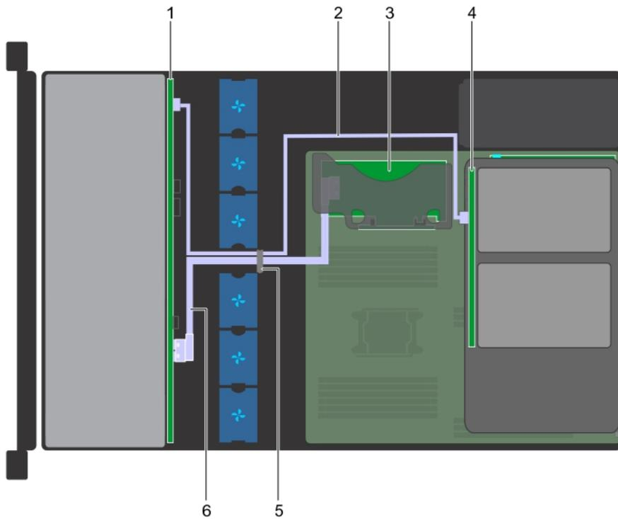
**Figure 103. Acheminement des câbles - backplane de système à 12 disques de 3,5 pouces et backplane arrière de système à 2 disques de 3,5 pouces avec une carte de montage PERC interne**
