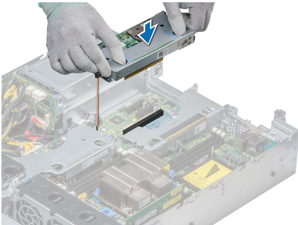
Figure 86. Installation de la carte de montage mi-hauteur gauche
