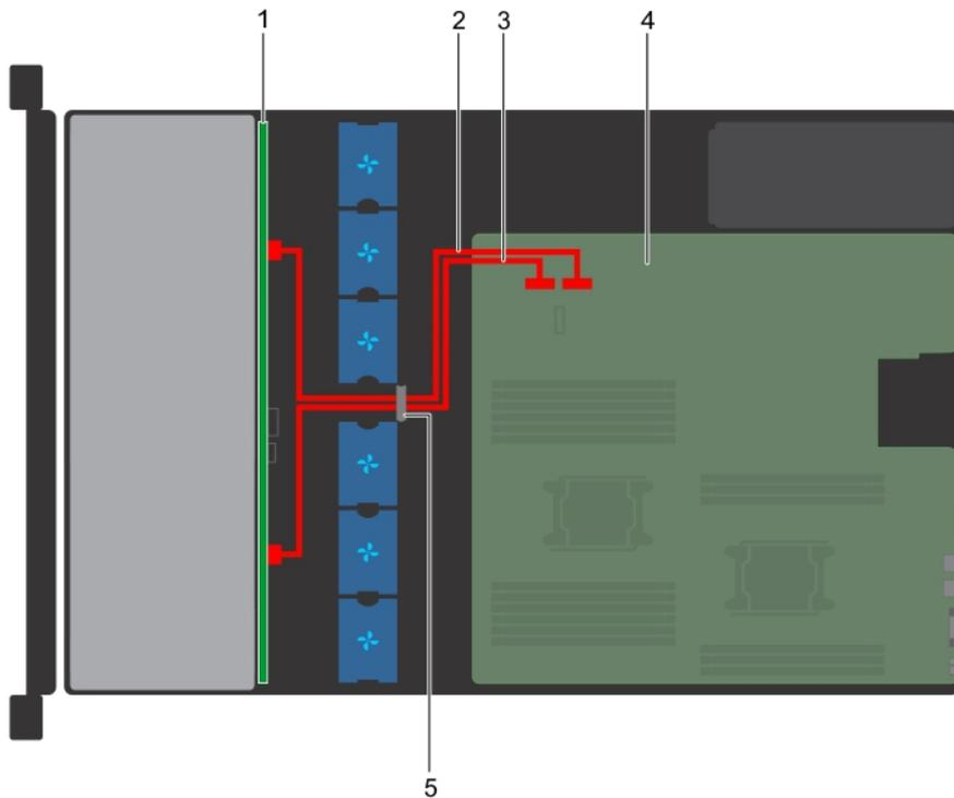
**Figure 106. Acheminement des câbles - backplane de système à 8 disques de 3,5 pouces**
