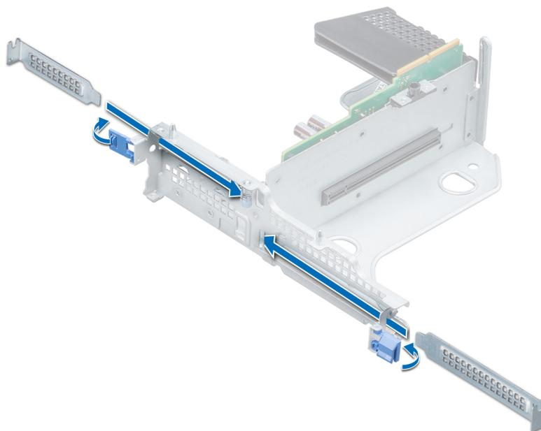
Figure 70. Installation d'une plaque de recouvrement pour la carte de montage papillon
