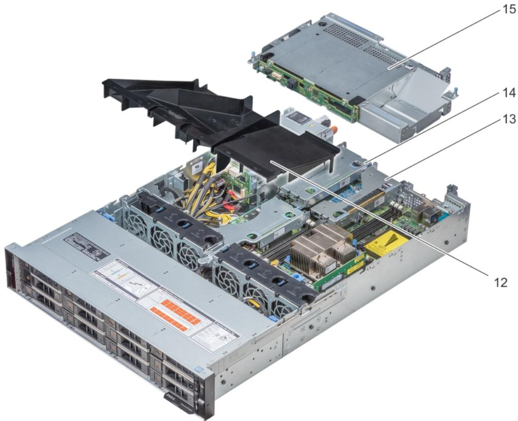
**Figure 30. Intérieur du système avec bâti de disques arrière**
