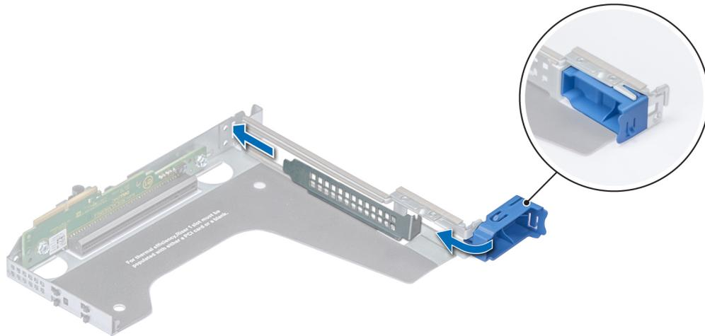
Figure 69. Installation d'une plaque de recouvrement pour la carte de montage pleine hauteur X1
