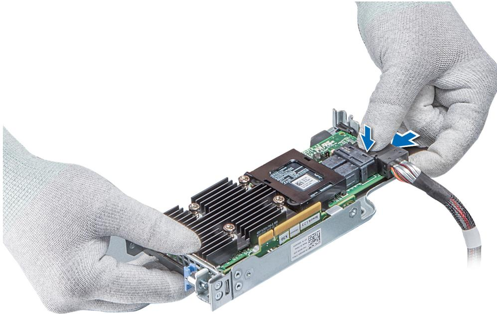
**Figure 39. Connexion du câble à la carte de montage PERC interne**
