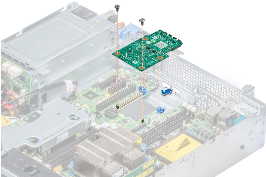
Figure 94. Installation de la carte de montage LOM
