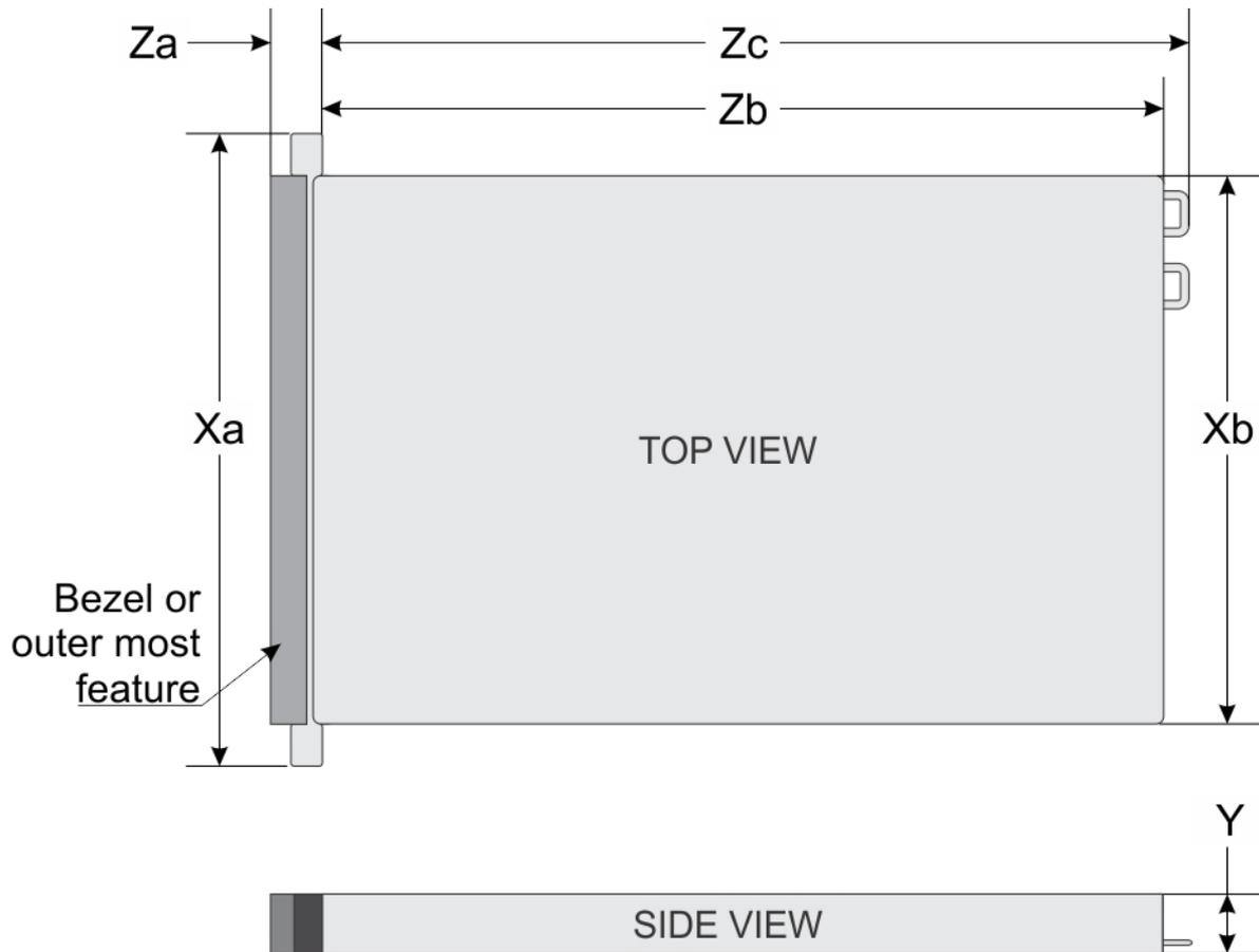
Figure 22. Dimensions du système Dell EMC PowerEdge R540
