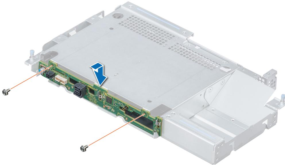
**Figure 102. Installation du backplane de disque arrière de 3,5 pouces**
