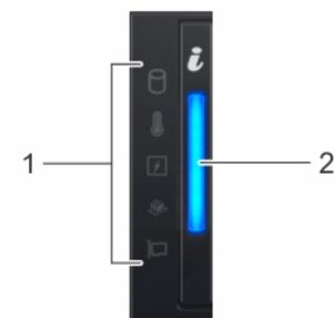
Figure 4. Vue du panneau de commande gauche sans le voyant iDRAC Quick Sync 2.0 en option
