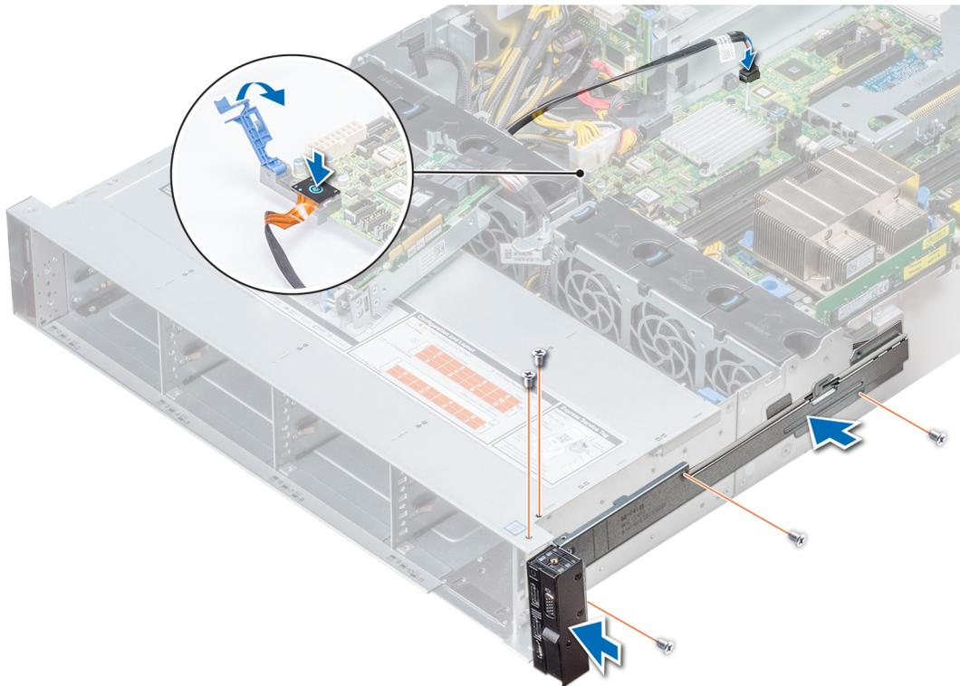
Figure 124. Installation du panneau de commande droit
