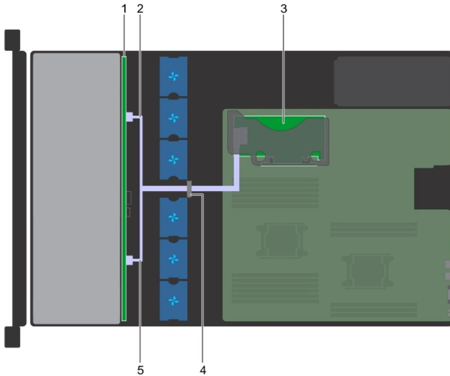
**Figure 104. Acheminement des câbles - backplane de système à 8 disques de 3,5 pouces avec une carte de montage PERC interne**
