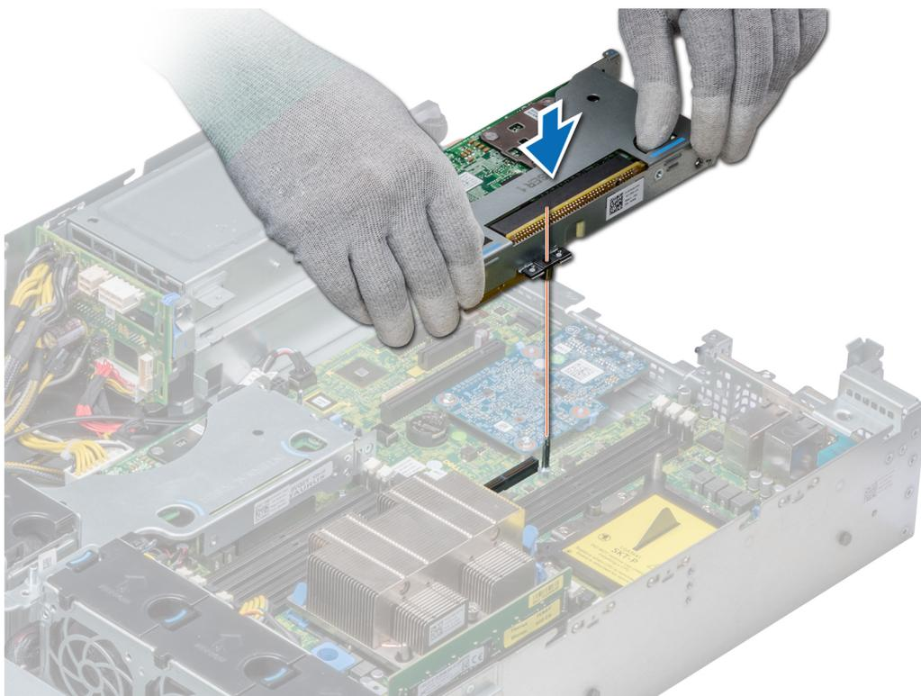
Figure 85. Installation de la carte de montage mi-hauteur droite
