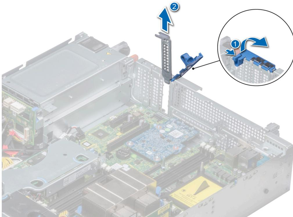
Figure 79. Retrait de la plaque de recouvrement
