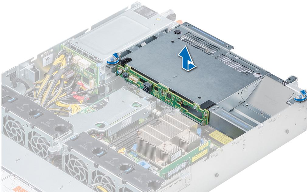
Figure 107. Retrait du bâti des disques arrière
