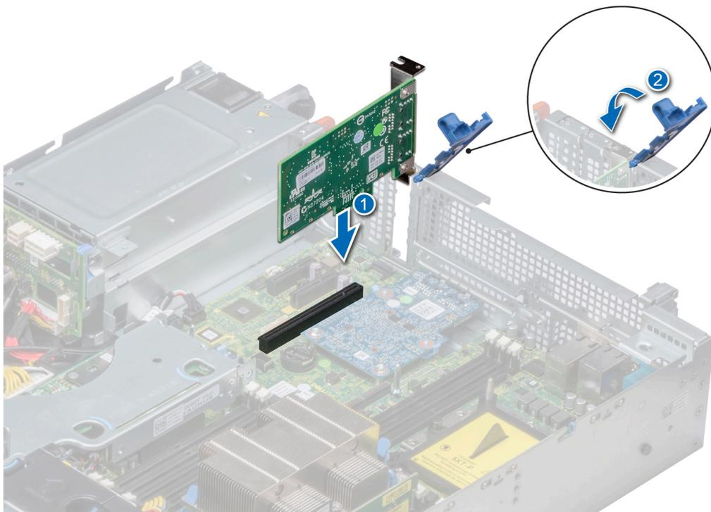
Figure 80. Installation d'une carte d'extension sur la carte système
