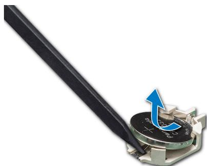
**Figure 109. Retrait de la pile du système**
