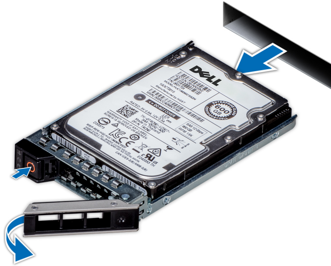
Figura 51. Extracción de una portadora de unidades
