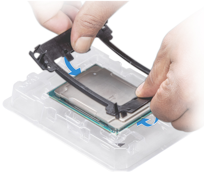
Figura 61. Instalación del soporte del procesador
