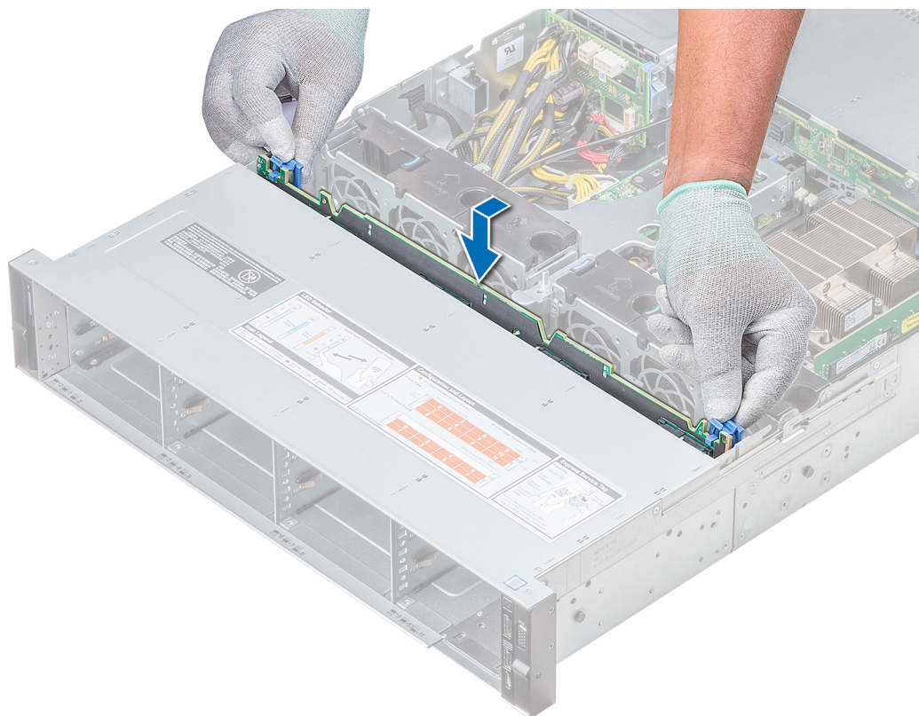
Figura 100. Instalación del plano posterior
