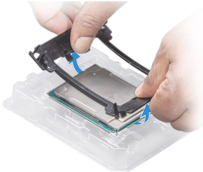
Figura 60. Extracción del soporte del procesador
