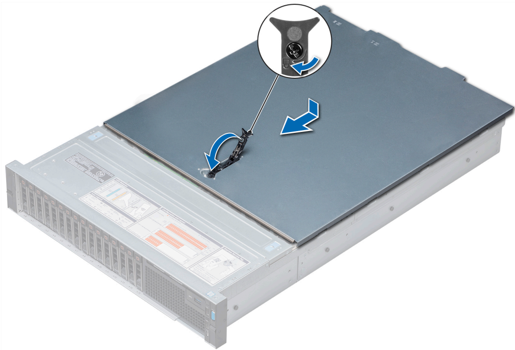
Abbildung 27. Installieren der Systemabdeckung
