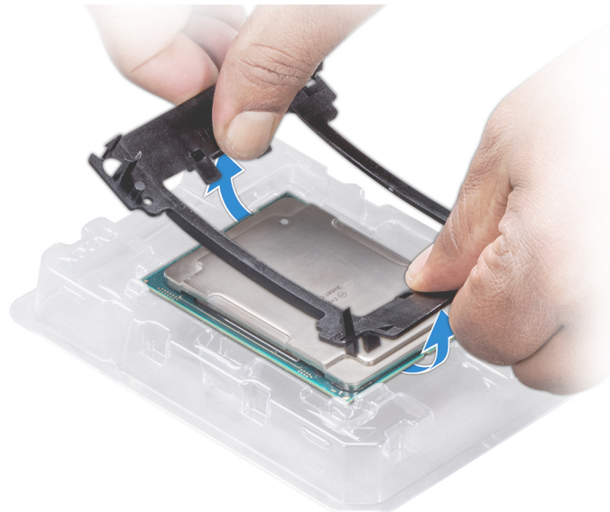
Abbildung 60. Entfernen der Prozessorhalterung
