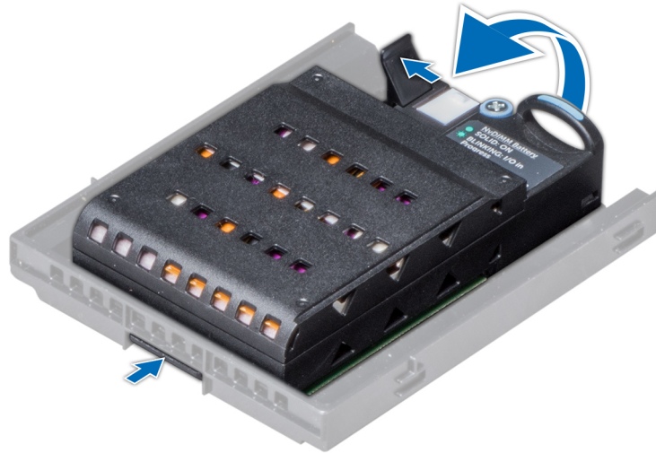
Abbildung 44. Entfernen des NVDIMM-N-Akkus aus der Halterung
