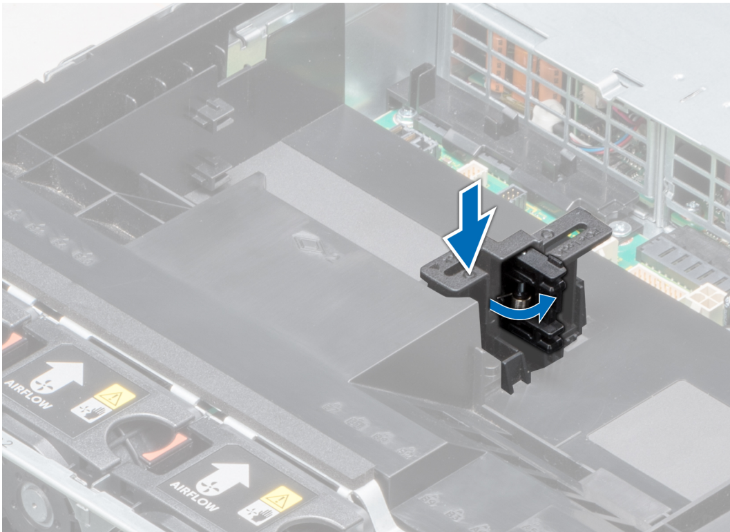
Abbildung 65. Öffnen des PCIe-Kartenhalterverriegelung
