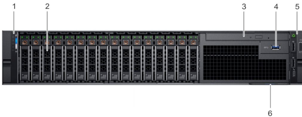
Abbildung 2. Vorderansicht eines Systems mit 16 x 2,5-Zoll-Laufwerksystemen
