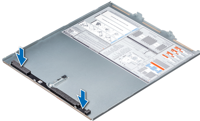
Abbildung 98. Anbringen des Schutzschaums an der Systemabdeckung
