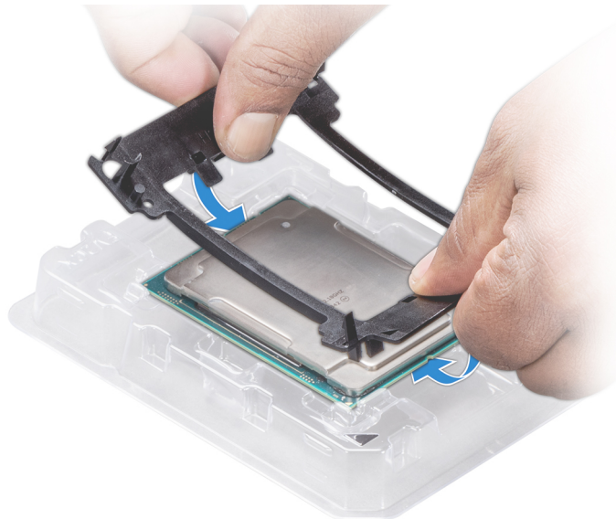
Abbildung 61. Installieren der Prozessor-Halterung
