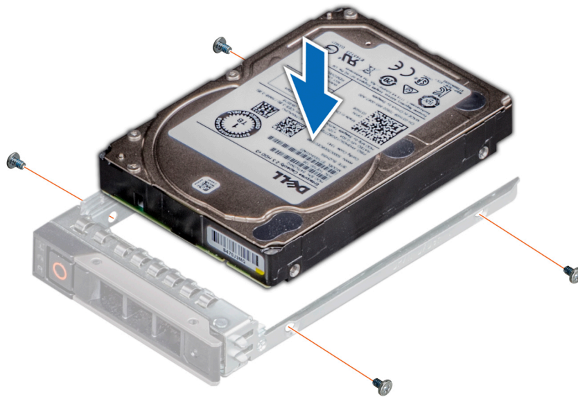
Abbildung 55. Einsetzen eines Laufwerks in den Laufwerksträger
