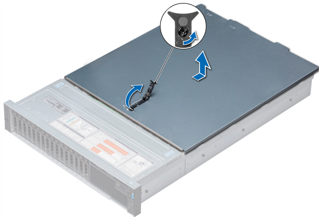
Figura 26. Extracción de la cubierta del sistema
