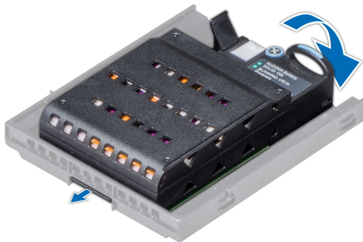
Figura 45. Instalación de la batería NVDIMM-N en el soporte
