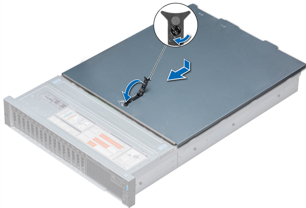
Figura 27. Instalación de la cubierta del sistema
