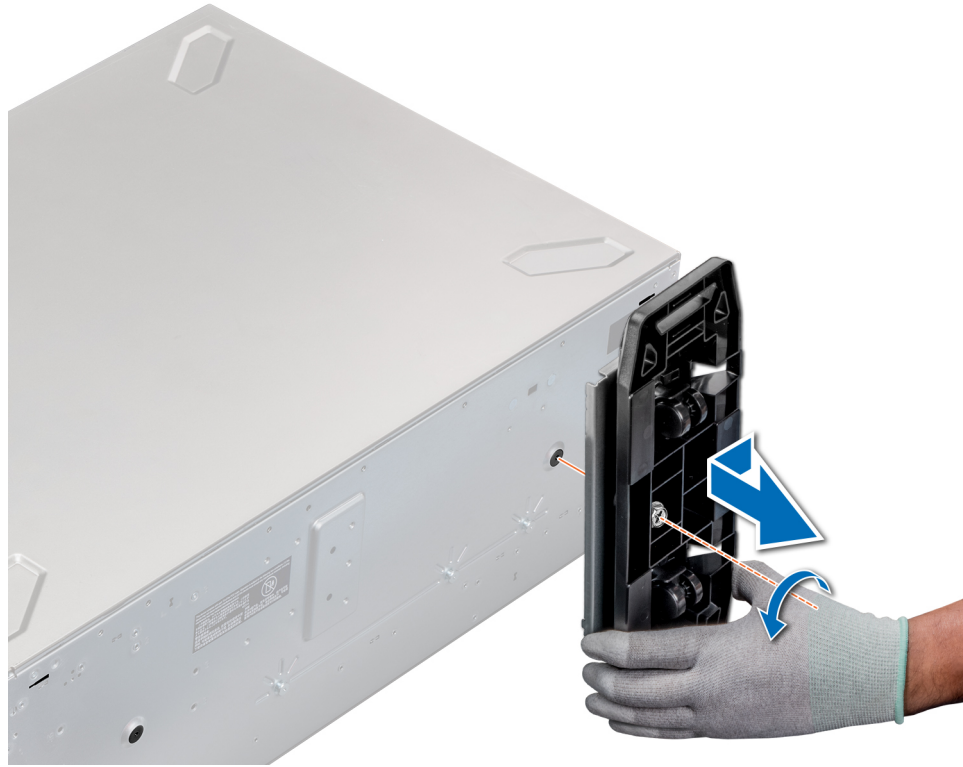
Abbildung 17. Entfernen von Gleitrollen
