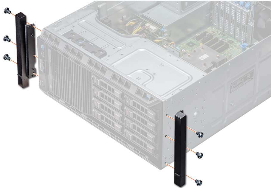
Abbildung 88. Installieren der Systemmontagewinkel
