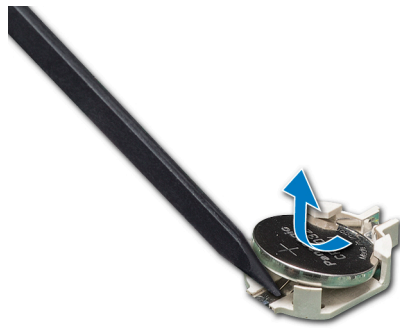
Abbildung 79. Entfernen der Systembatterie
