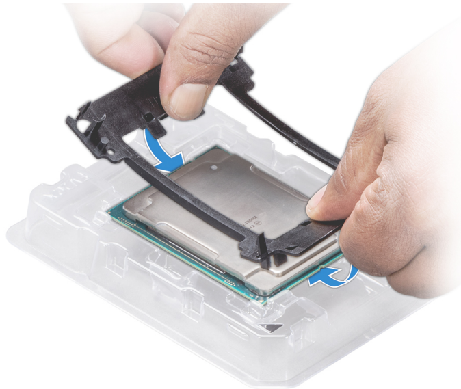
Abbildung 67. Installieren der Prozessor-Halterung
