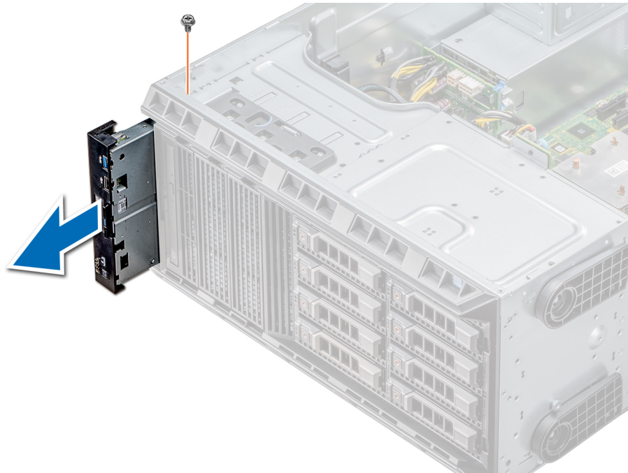
Abbildung 81. Entfernen der Bedienfeldbaugruppe
