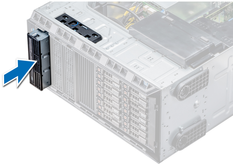
Abbildung 36. Installieren des optischen Laufwerks oder des Bandlaufwerks
