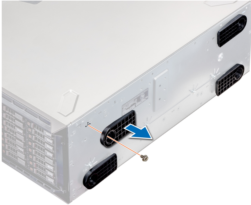
Abbildung 15. Entfernen der Standfüße
