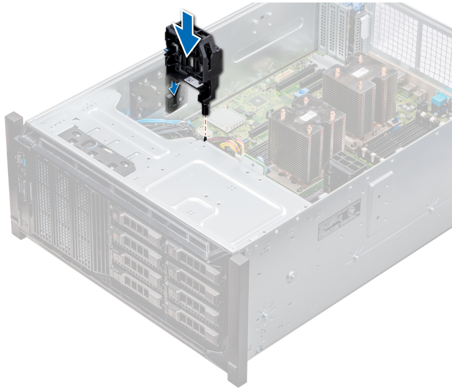
Abbildung 68. Installieren des optionalen GPU-Kartenhalters
