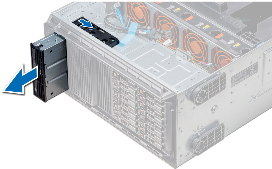
Abbildung 50. Entfernen des optischen Laufwerks oder des Bandlaufwerks
