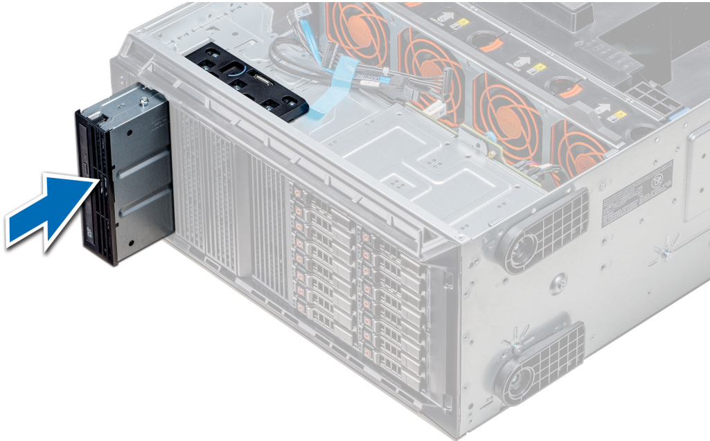
Abbildung 51. Installieren des optischen Laufwerks oder des Bandlaufwerks
