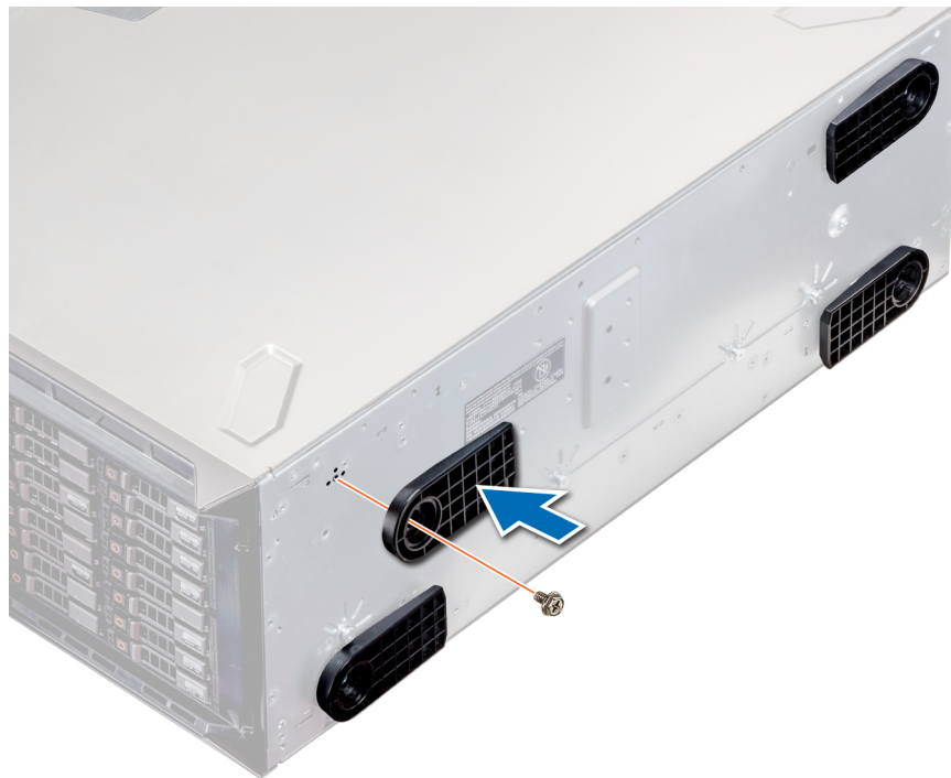
Abbildung 18. Installieren der Standfüße
