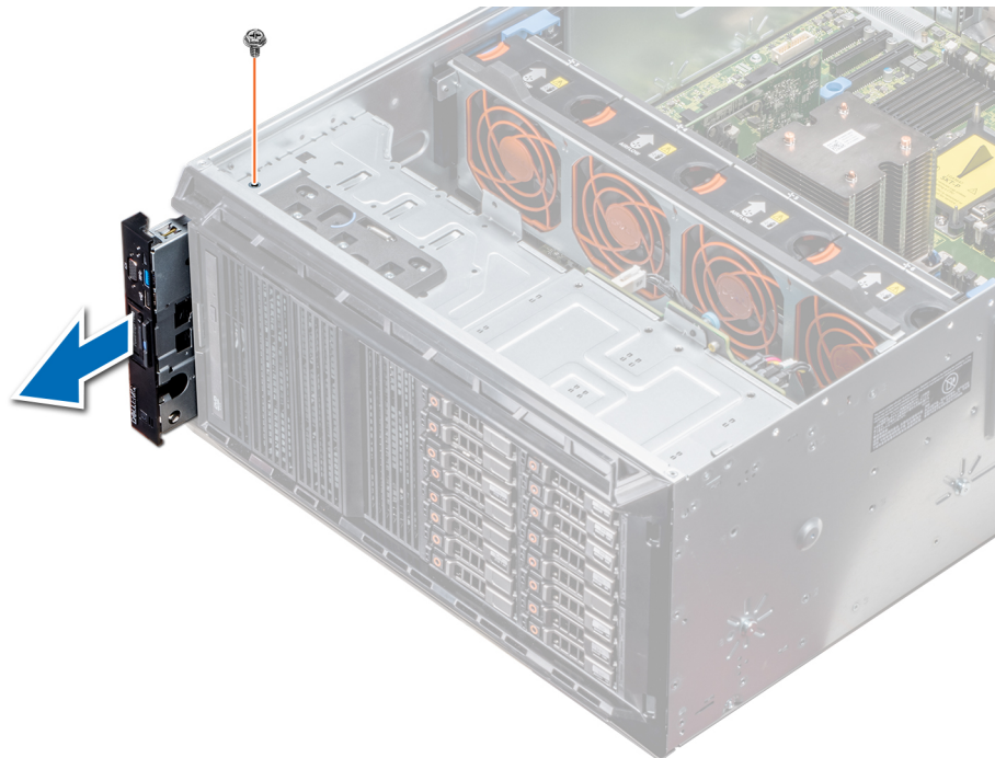
Abbildung 101. Entfernen der Bedienfeldbaugruppe
