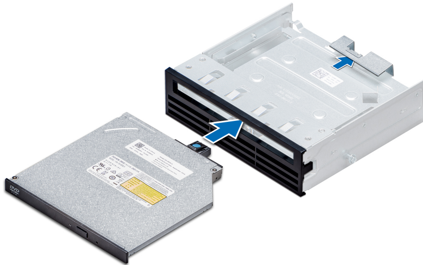
Abbildung 53. Installieren des Platzhalters für das optische Laufwerk in Flachbauweise
