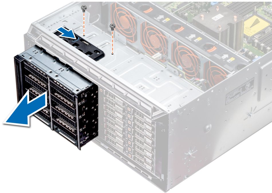
Abbildung 46. Entfernen eines NVMe-Laufwerkschachts oder Flex Bay-Schachts
