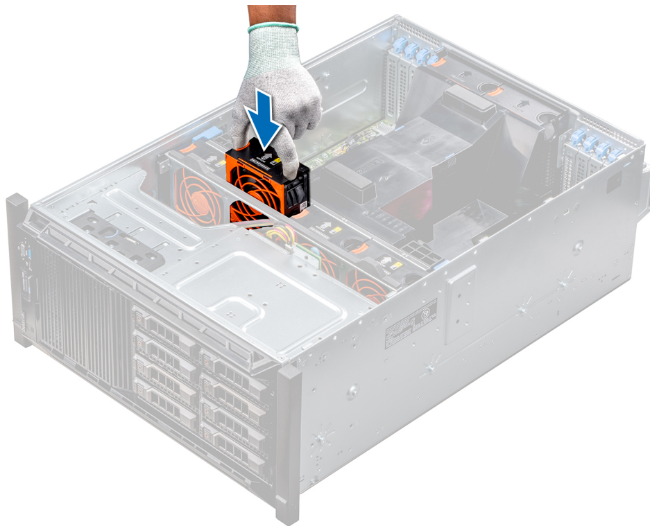
Abbildung 41. Einsetzen eines Kühlungslüfters
