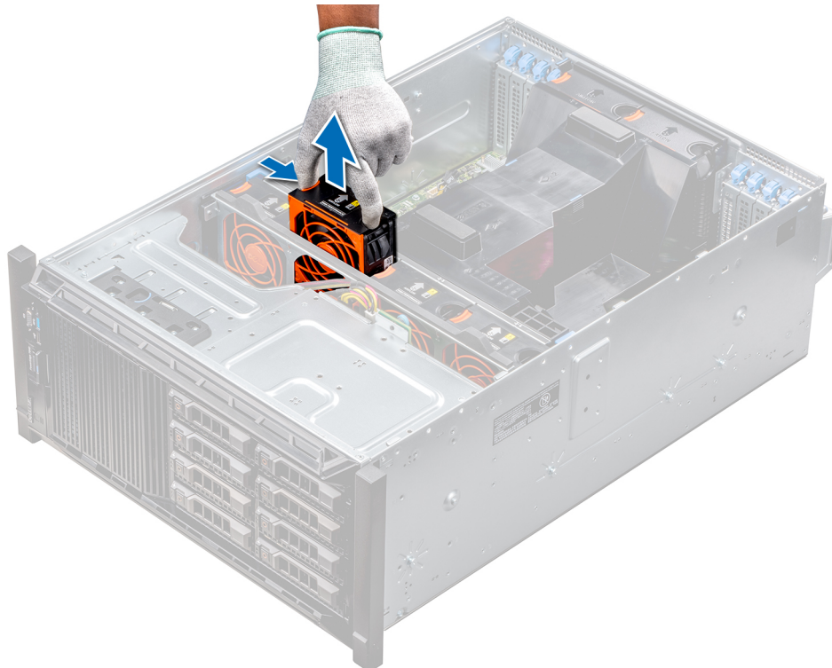
Abbildung 40. Entfernen eines Kühlungslüfters
