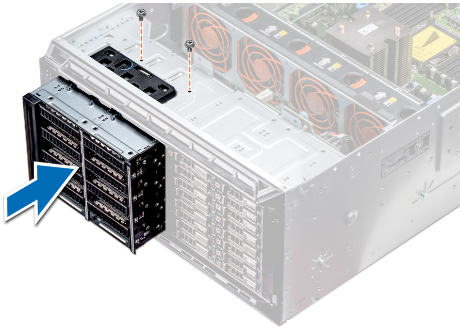
Abbildung 47. Installieren eines NVMe-Laufwerkschachts oder Flex Bay-Schachts
