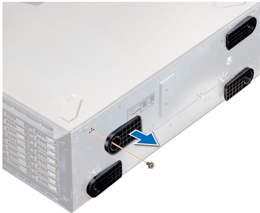
Abbildung 17. Entfernen der Standfüße
