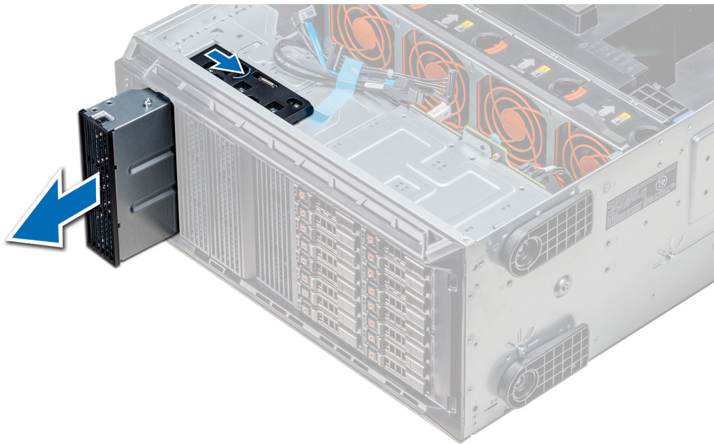
Abbildung 48. Entfernen des optischen Laufwerks oder Bandlaufwerks
