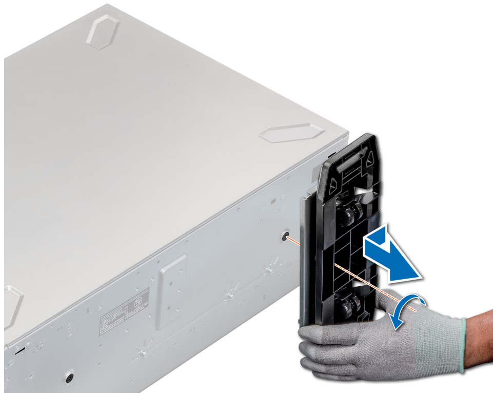
Abbildung 19. Entfernen von Gleitrollen
