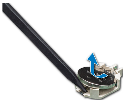
Abbildung 89. Entfernen der Systembatterie
