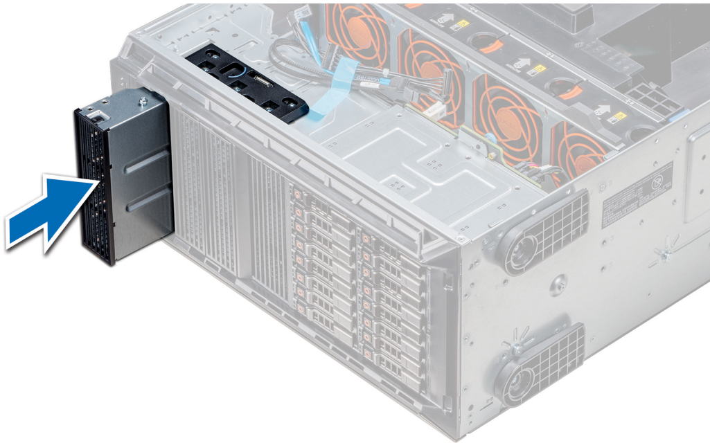
Abbildung 49. Installieren des Platzhalters für optische Laufwerke oder Bandlaufwerke
