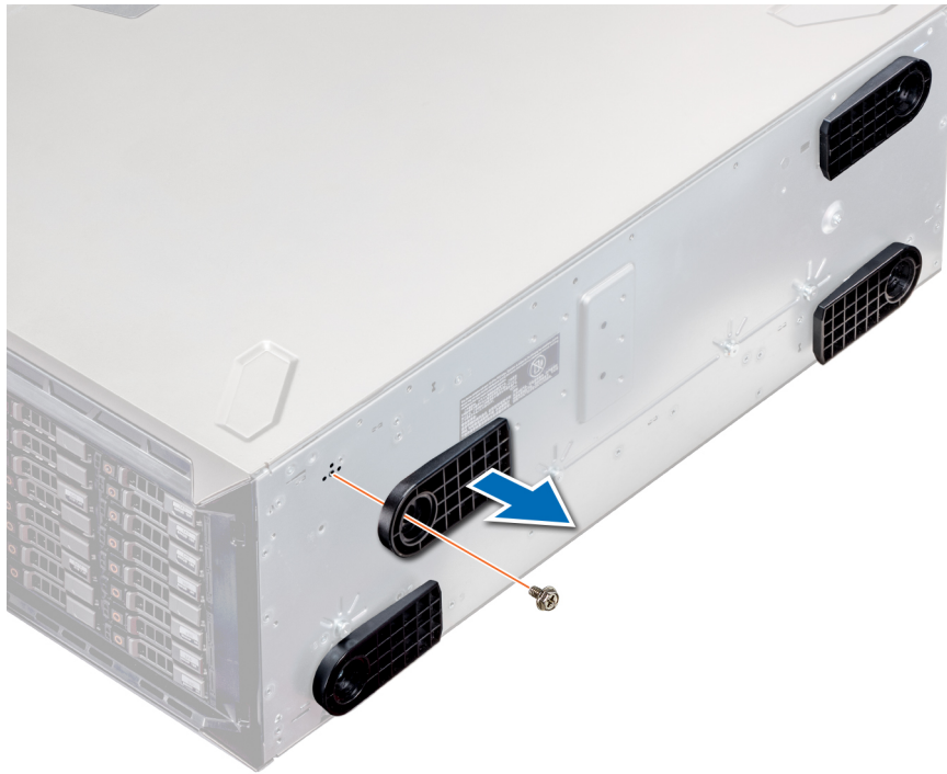
Abbildung 23. Entfernen der Standfüße
