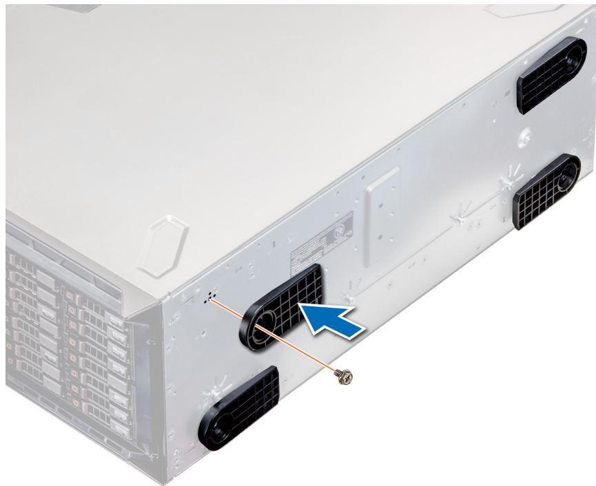
Abbildung 24. Installieren der Standfüße
