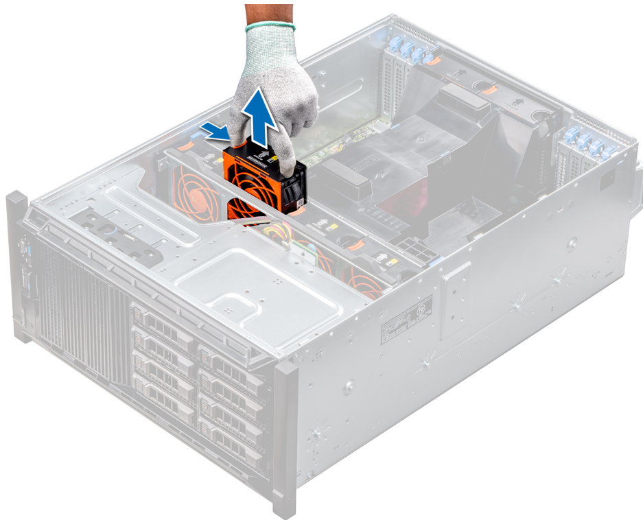
Abbildung 47. Entfernen eines mittleren Kühlungslüfters
