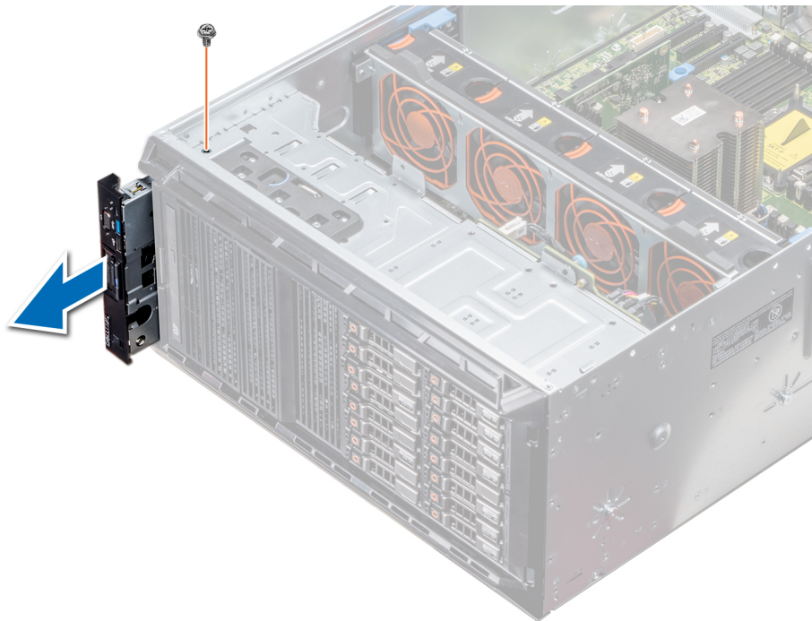
Abbildung 100. Entfernen der Bedienfeldbaugruppe
