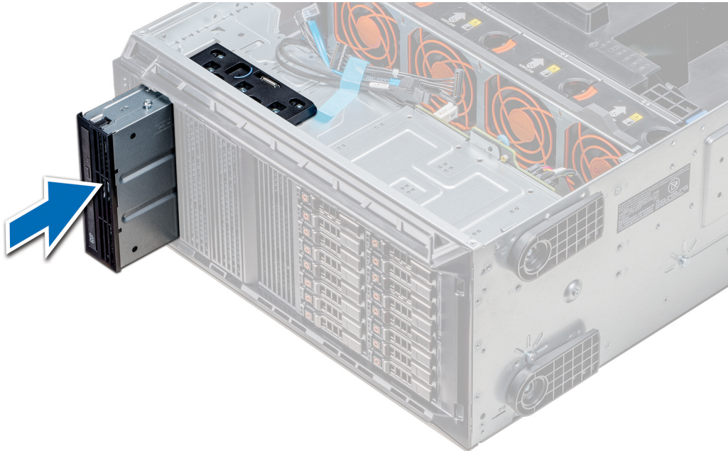
Abbildung 58. Installieren des optischen Laufwerkgehäuses oder Bandlaufwerks
