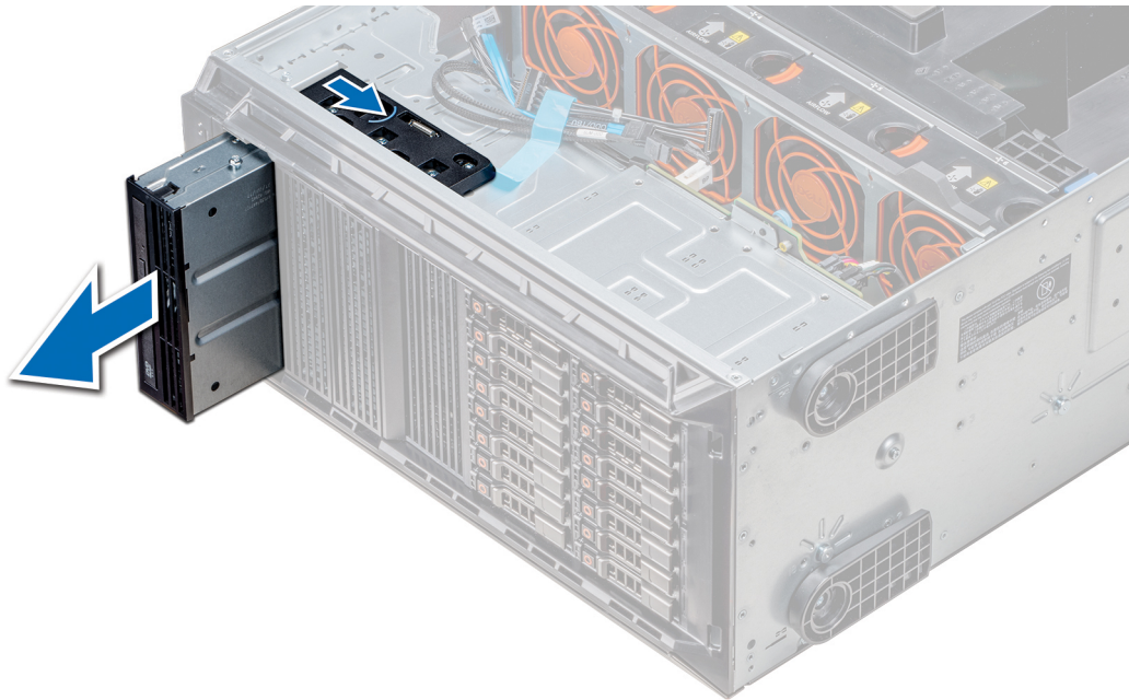
Abbildung 57. Entfernen des Gehäuses des optischen Laufwerks oder Bandlaufwerks
