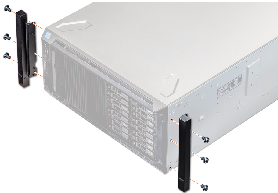
Abbildung 116. Installieren der Systemwinkel
