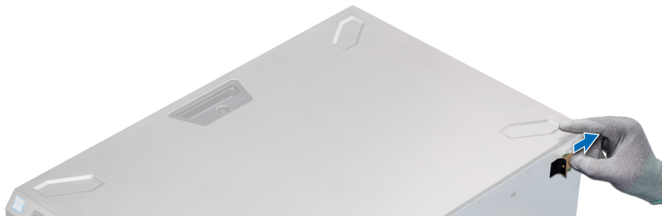
Abbildung 115. Anbringen der Schutzfolie
