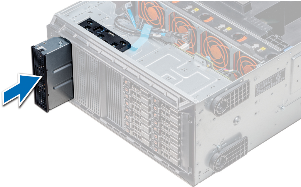
Abbildung 56. Installieren des Platzhalters für ein optisches Laufwerk oder Bandlaufwerk
