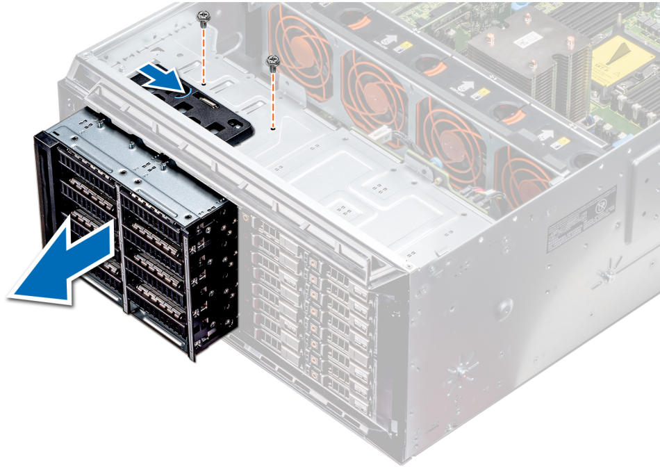
Abbildung 53. Entfernen eines NVMe-Laufwerkschachts oder FlexBay-Schachts
