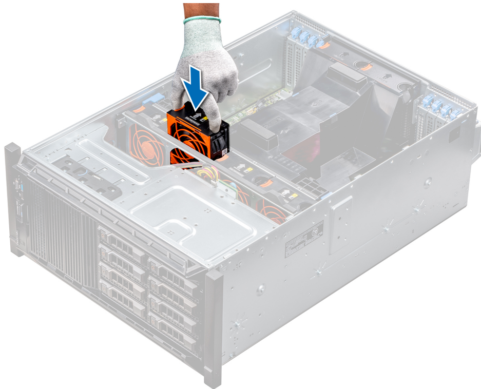
Abbildung 48. Installieren eines mittleren Kühlungslüfters
