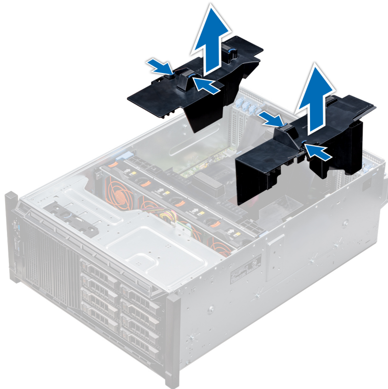
Abbildung 43. Entfernen der optionalen GPU-Kühlgehäuse
