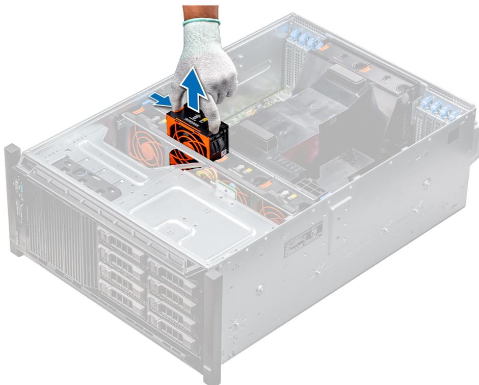
Figure 21. Retrait d'un ventilateur de refroidissement central
