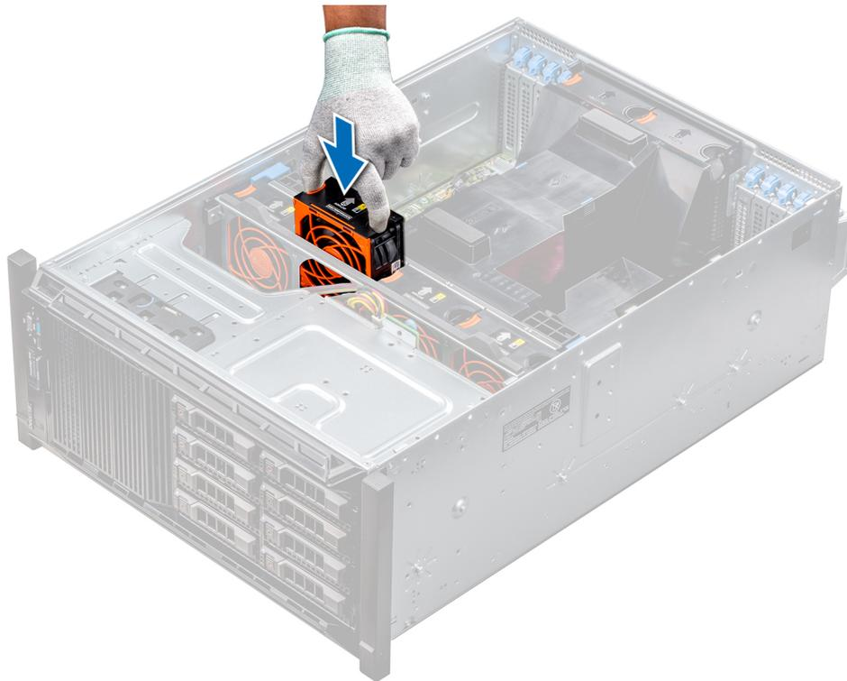
Figure 22. Installation d'un ventilateur de refroidissement central
