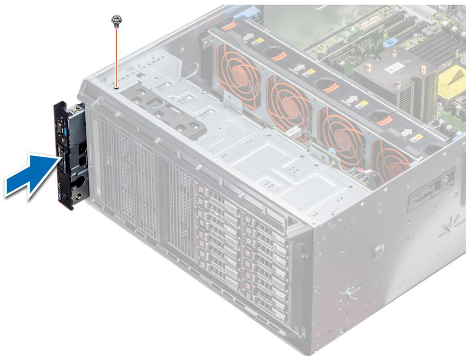
**Figure 109. Installation de l'assemblage du panneau de commande**
