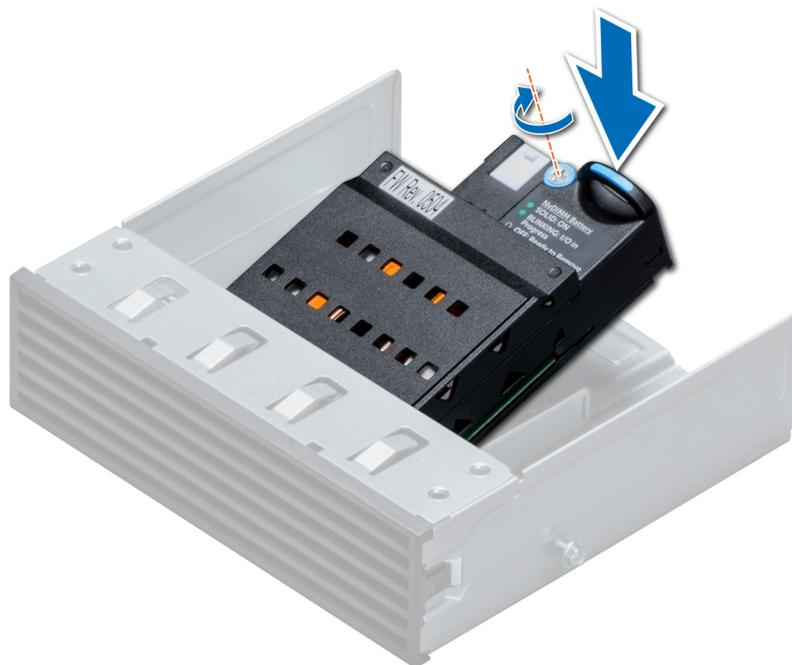
Figure 66. Installation de la pile NVDIMM-N
