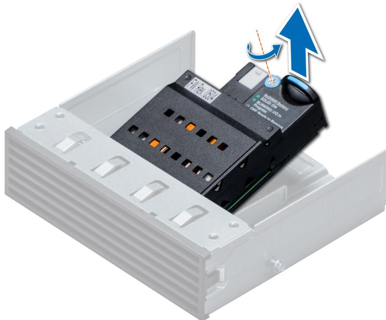
Figure 65. Retrait de la pile du module NVDIMM-N
