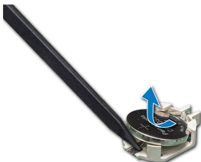
**Figure 104. Retrait de la pile du système**
