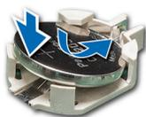
**Figure 105. Installation de la pile du système**
