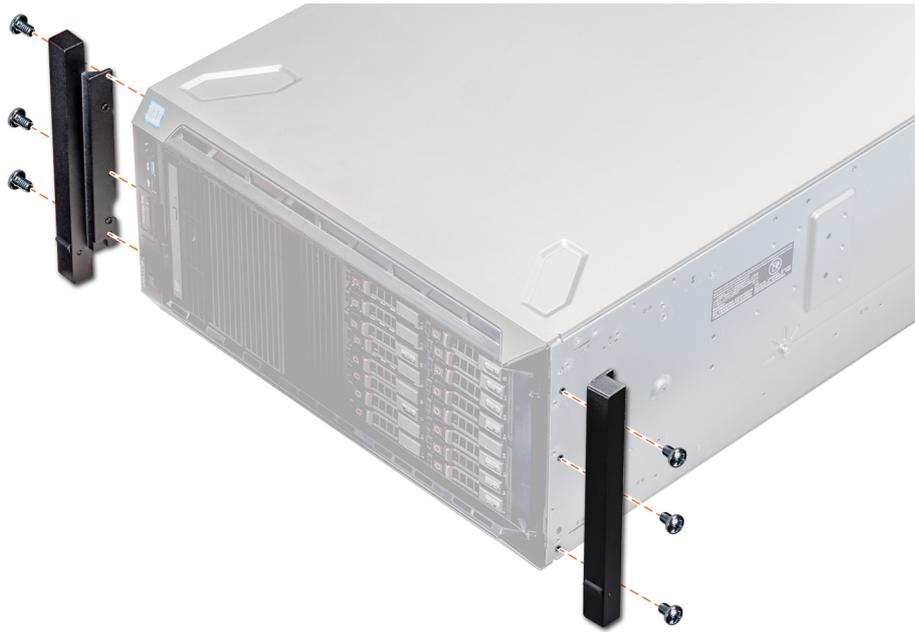
**Figure 122. Installation des équerres du système**
