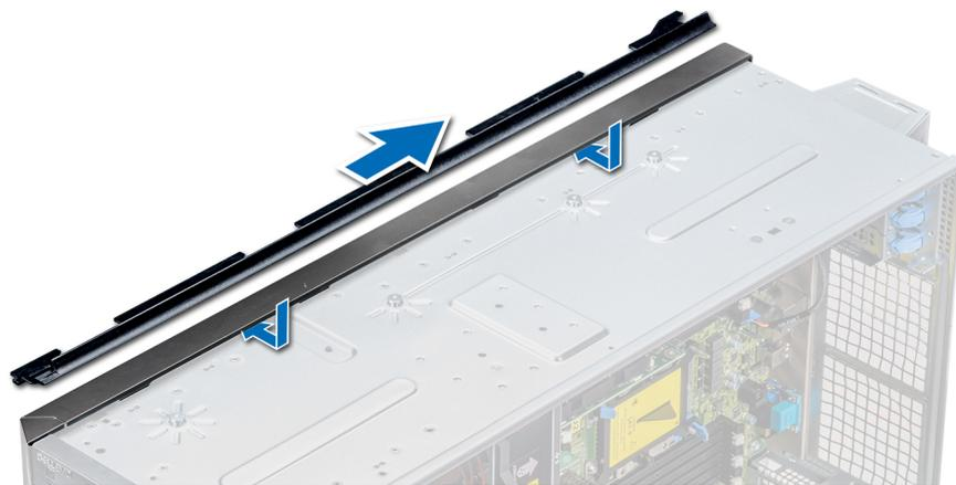
**Figure 120. Installez le capot coulissant du rack**
