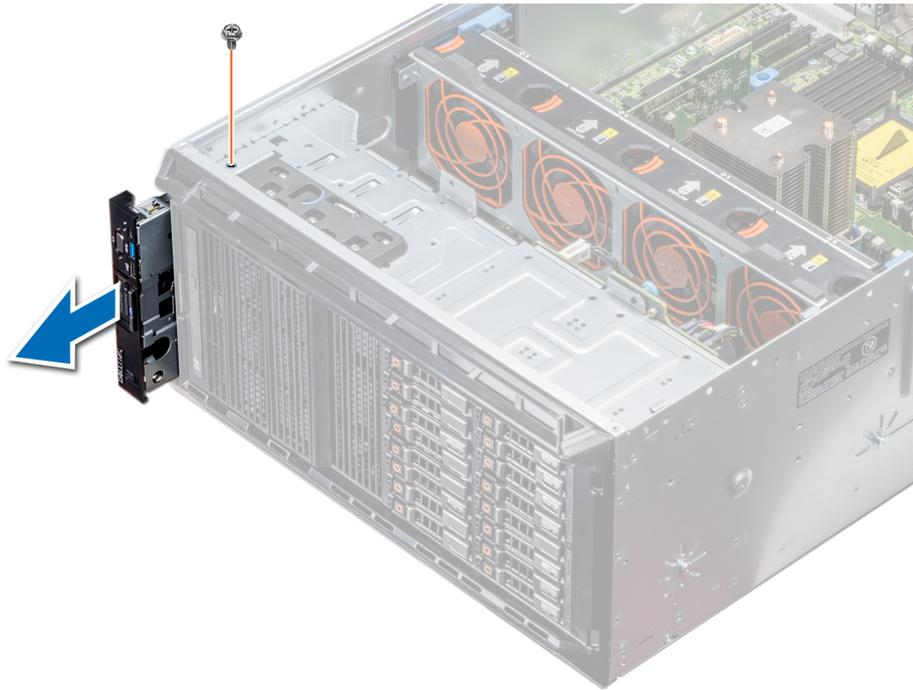
**Figure 106. Retrait de l'assemblage du panneau de commande**
