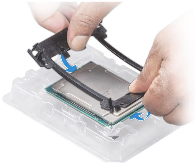
**Figure 73. Installation du support de processeur**
