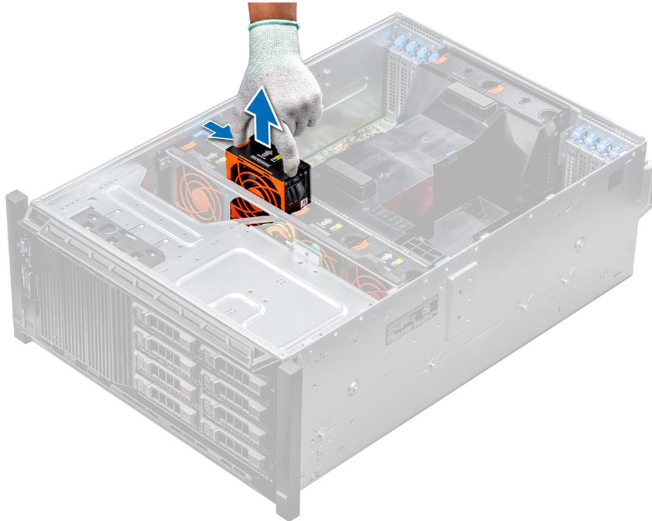
Abbildung 51. Entfernen eines mittleren Kühlungslüfters
