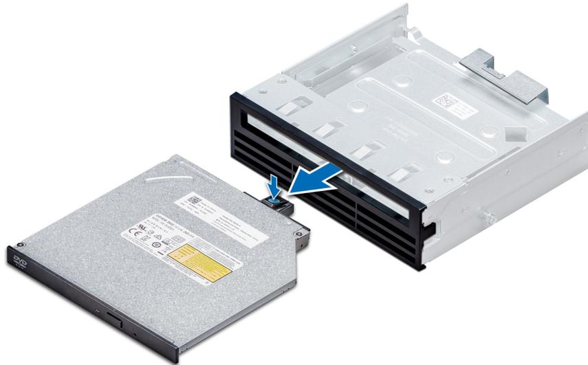
**Abbildung 63. Entfernen des Platzhalters für das optische Laufwerk in Flachbauweise**
