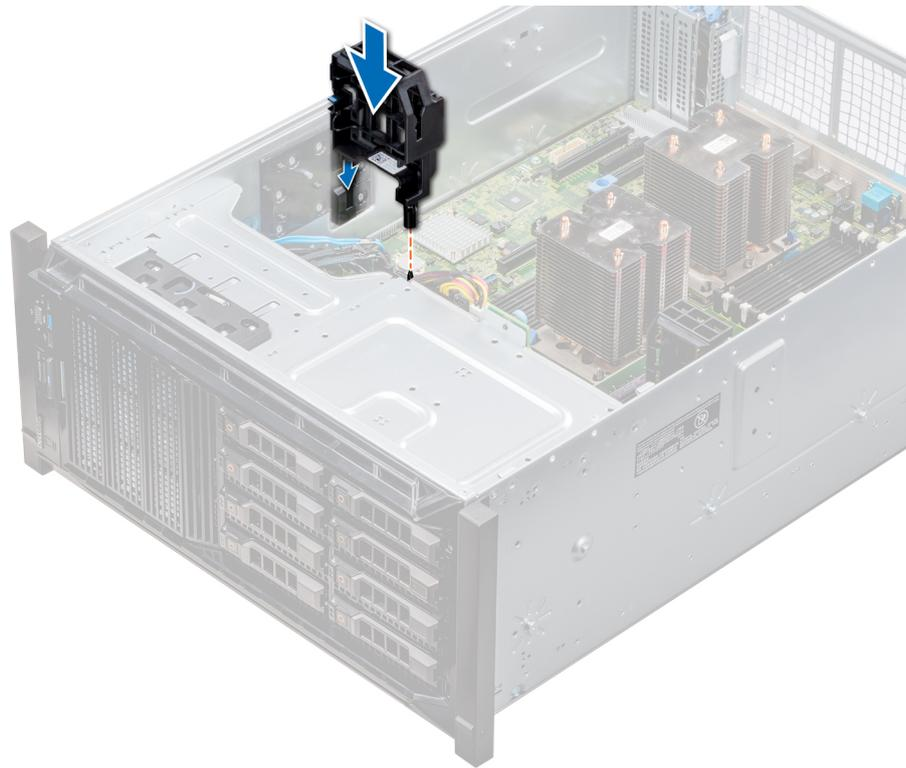
Abbildung 80. Installieren des optionalen GPU-Kartenhalters
