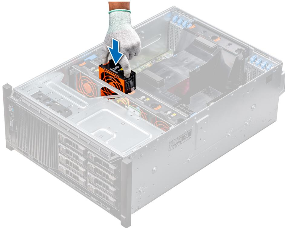
**Abbildung 22. Installieren eines mittleren Kühlungslüfters**
