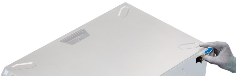
**Abbildung 121. Anbringen der Schutzfolie**
