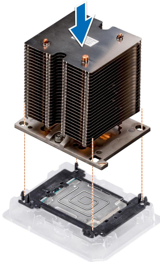
Abbildung 75. Setzen des Kühlkörpers auf den Prozessor ein
