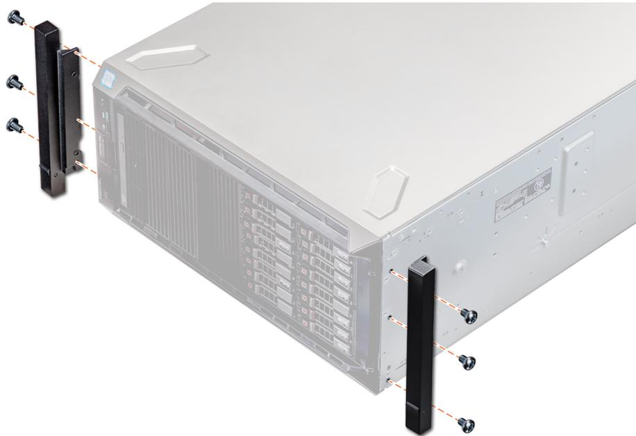
**Abbildung 122. Installieren der Systemwinkel**
