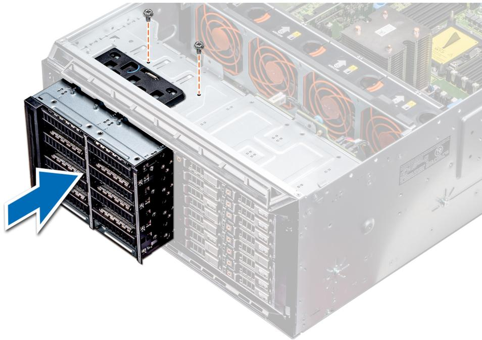
**Abbildung 58. Installieren eines NVMe-Laufwerkschachts oder FlexBay-Schachts**
