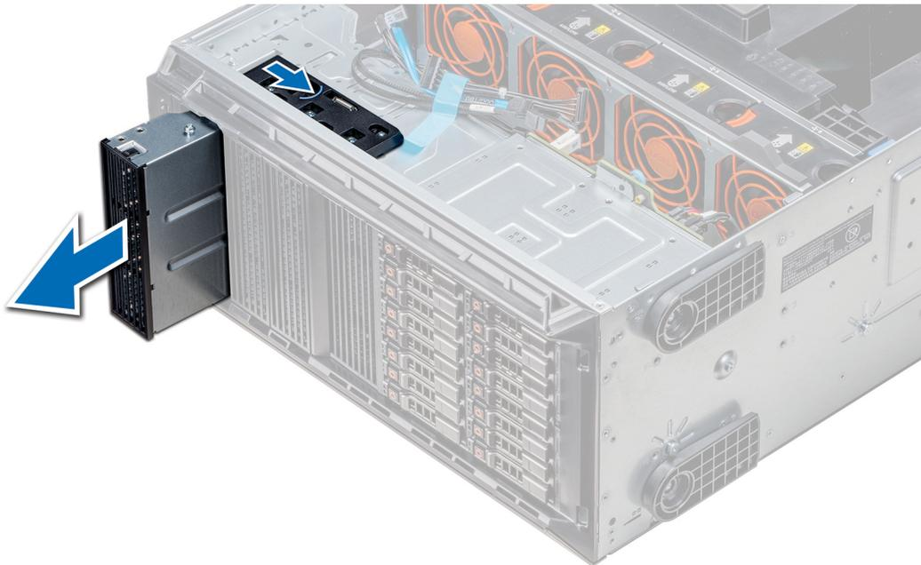
Abbildung 59. Entfernen des optischen Laufwerks oder Bandlaufwerks
