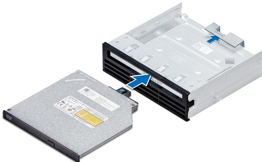
**Abbildung 64. Installieren des Platzhalters für das optische Laufwerk in Flachbauweise**
