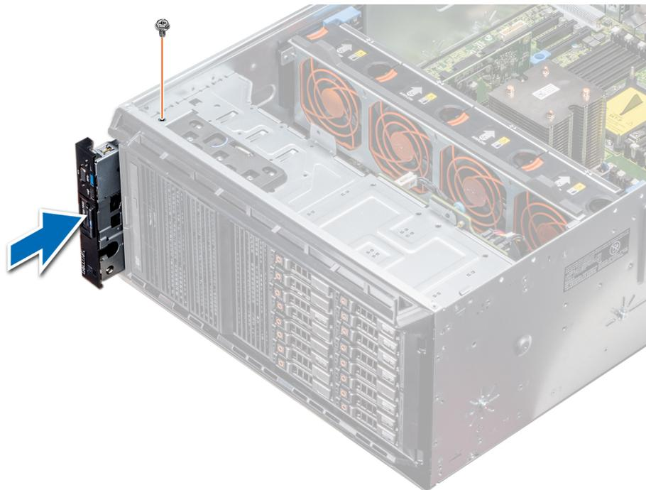
**Abbildung 109. Installieren der Bedienfeldbaugruppe**
