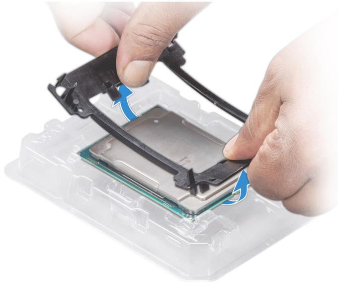
Abbildung 72. Entfernen der Prozessorhalterung
