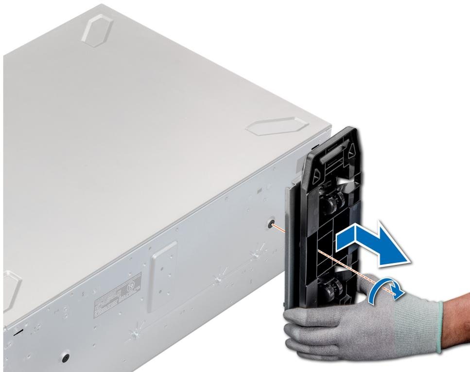
Abbildung 30. Installieren von Gleitrollen
