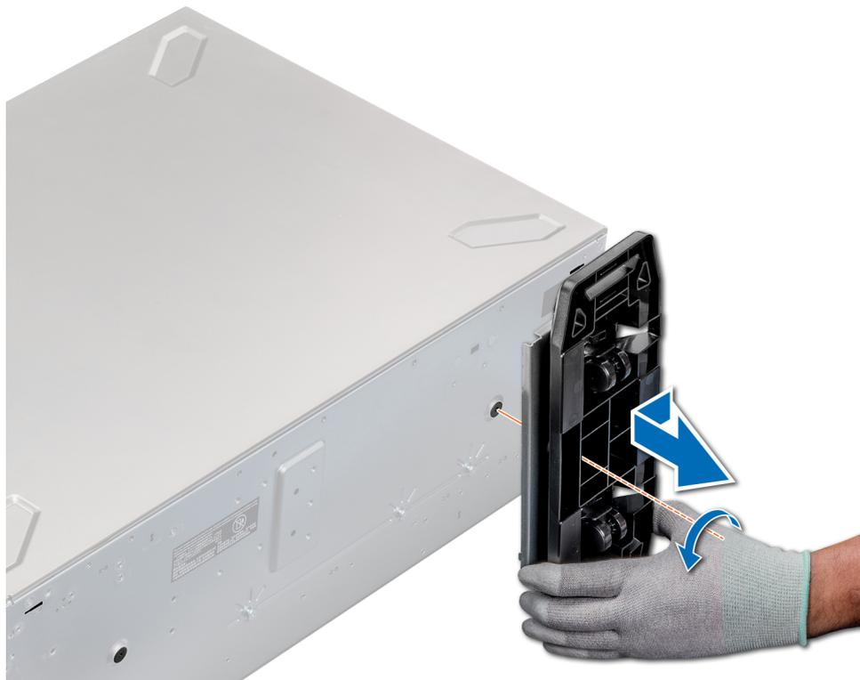
Abbildung 29. Entfernen von Gleitrollen
