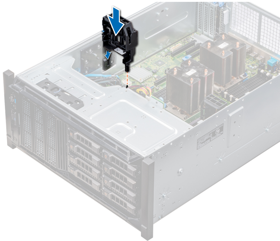
Figura 76. Instalación del soporte para tarjetas GPU
