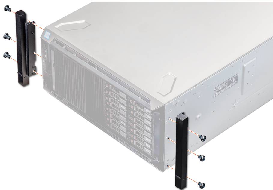
Figura 116. Instalación de las orejas del sistema
