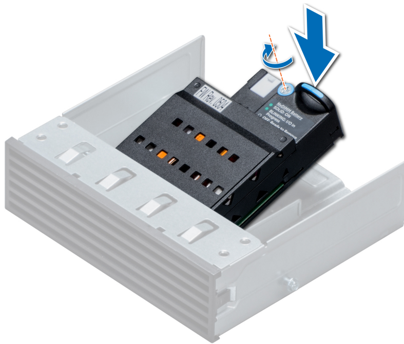
Figura 62. Instalación de la batería NVDIMM-N
