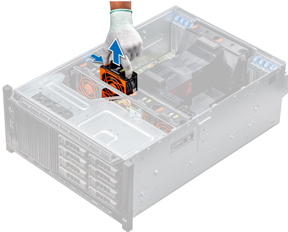
Figura 47. Extracción de un ventilador de refrigeración intermedio
