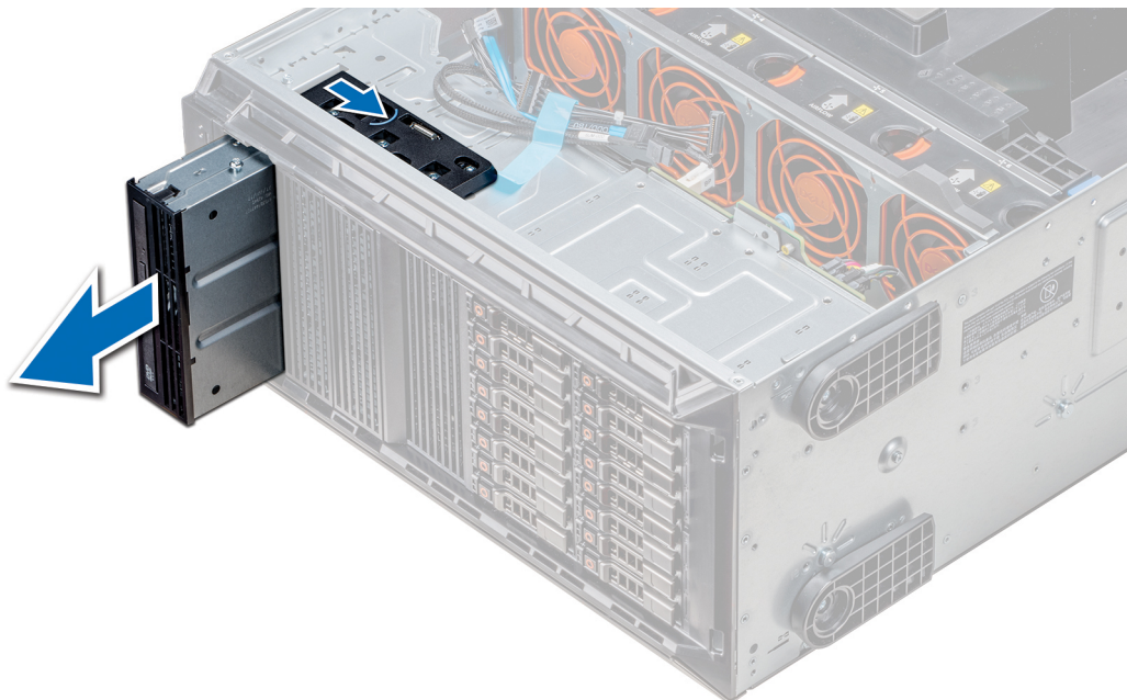
Figura 57. Extracción de la caja de la unidad óptica o la unidad de cinta
