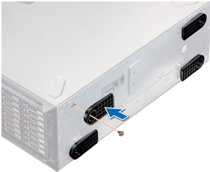
Figura 24. Instalación de los pies del sistema
