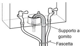
Reinstallare il tubo di scarico.
