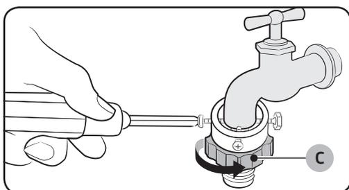
4. Inserire l'adattatore nel rubinetto di carico dell'acqua e serrare le viti sollevando allo stesso tempo l'adattatore.
