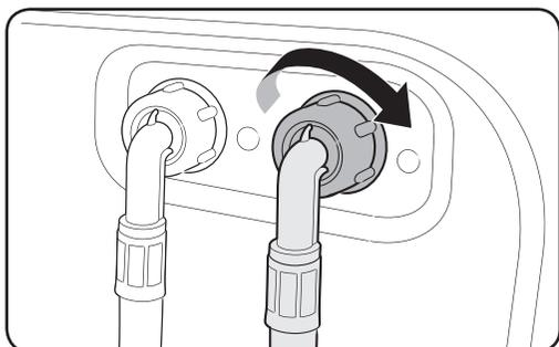
1. Collegare l'estremità rossa del tubo di carico dell'acqua calda alla presa di carico dell'acqua calda posta sul retro della lavabiancheria.
