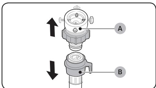
**Collegare il tubo di carico dell'acqua al rubinetto di carico dell'acqua.**
