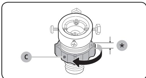
3. Afferrare l'adattatore e ruotare il componente (C) nella direzione della freccia per allentarlo di 5 mm (\*).
