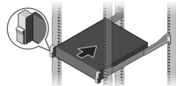
**1** Install the system into a rack. Installez le système dans le rack. Setzen Sie das System in ein Rack ein. **Установите систему на стеллаж.** Instalación del sistema en un rack. התקן את המערכת במדף.
