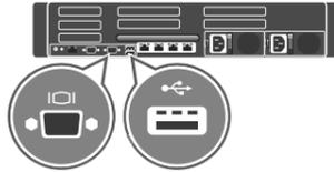
**2** Connect the keyboard, mouse, and monitor (optional). Connectez le clavier, la souris et le moniteur (facultatif). Schließen Sie die Tastatur, die Maus und den Monitor (optional) an. **Подсоедините клавиатуру, мышь и монитор (приобретаются дополнительно).** Conecte el teclado, el ratón y el monitor (opcional). חבר את המקלדת, העכבר והצג (אופציונלי).
