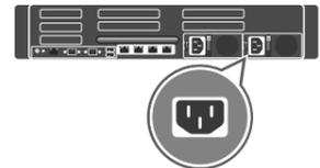
**3** Connect the system to a power source. Connectez le système à une source d'alimentation. Schließen Sie das System an eine Energiequelle an. **Подсоедините систему к источнику питания.** Conecte el sistema a una fuente de alimentación. חבר את המערכת למקור מתח.
