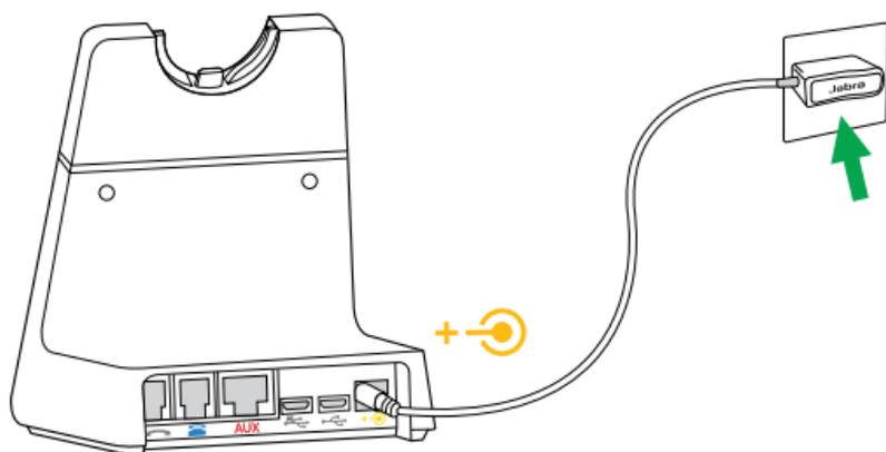
Conecte la base a la red eléctrica con el cable de carga incluido.
