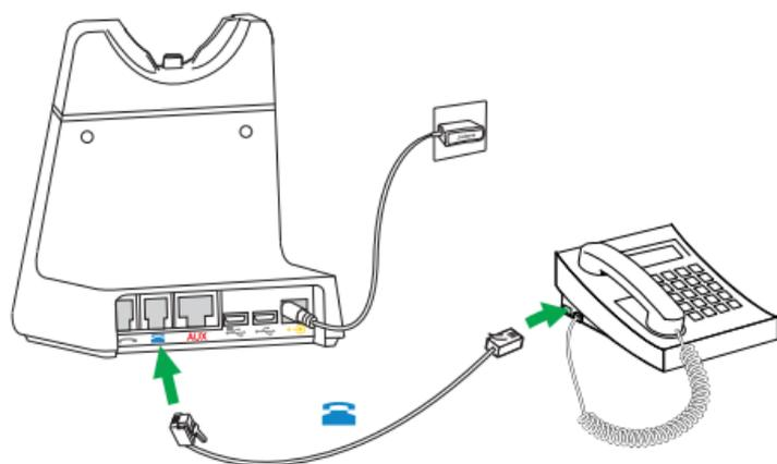
1. Enchufe el cable de teléfono suministrado en el puerto marcado con
