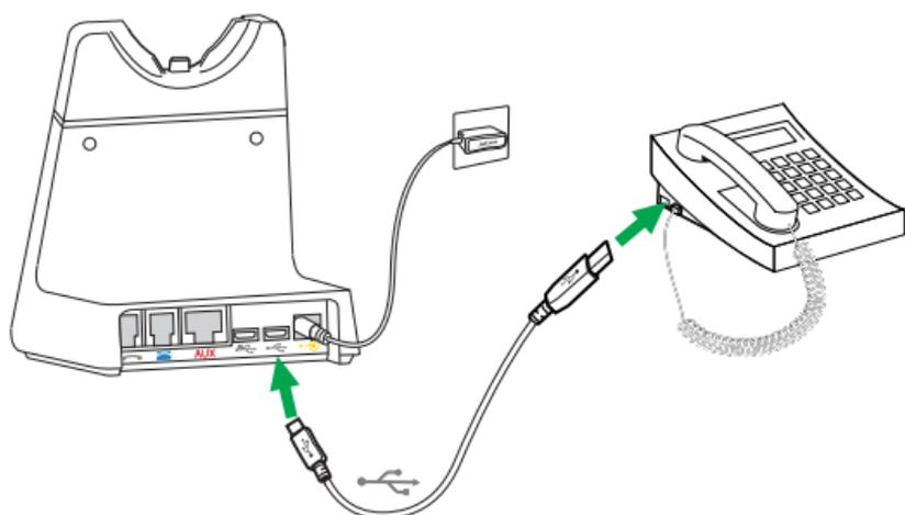
1. Enchufe el cable Micro-USB en el puerto marcado con
