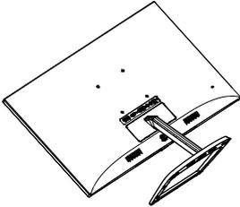
2. Allentare con le dita la vite che si trova nella parte inferiore della base, e rimuovere la base dal supporto.
