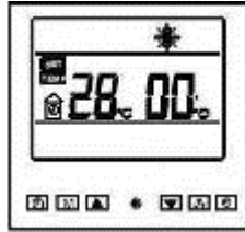
Figuur 16: Knopblokkering, verwarmingsmodus.
