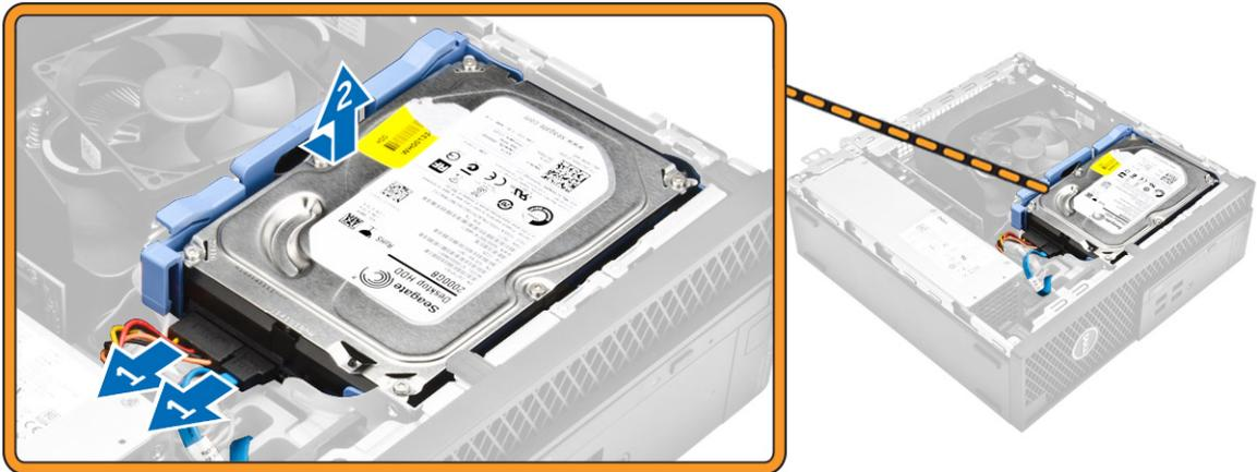
4. So entfernen Sie die Laufwerkshalterung:
