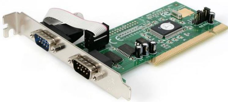
La tarjeta de 2 Puertos Serie 16550 (PCI2S550) se puede instalar en una ranura PCI disponible para añadir dos puertos serie RS232 a su sistema. Una solución eficaz y económica que permite conectar cualquier dispositivo serial nuevo o antiguo pudiendo alcanzar velocidades de transferencia de hasta 115,2 Kbps.
