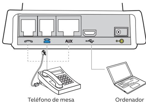
En primer lugar, conecte los cables del teléfono de sobremesa y el PC a la base. Para obtener más información sobre su teléfono específico, consulte <http://www.jabra.com/compatibilityguide>
