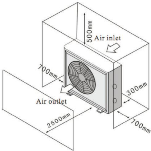
**Attention:** Ne placez pas l'appareil dans un espace confiné disposant d'un volume d'air limité, car l'air rejeté par l'appareil serait réutilisé. Ne le placez pas non plus près de buissons qui pourraient bloquer l'arrivée d'air. Ces endroits empêchent en effet l'appareil de s'alimenter continuellement en air frais, ce qui réduit l'efficience et peut mener à un débit de chaleur inadéquat.
