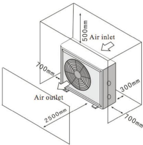
**OPGEPAST:** Plaats het toestel niet in een afgesloten ruimte met een beperkt luchtvolume waar de uitgestoten lucht opnieuw gebruikt zou worden, of dicht bij struiken die de lucht inlaat kunnen blokkeren.
