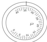
Drehen Sie im Uhrzeigersinn, dann nimmt die Temperatur ab.
