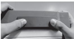
25. Desmonte las juntas del frigorífico y del congelador y vuelva a montarlas tras girarlas 180°.
