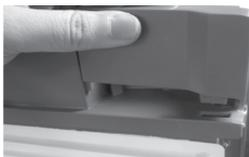
23. Inserte la cubierta del cable de la puerta en la parte superior de la puerta del frigorífico y empuje la cubierta hasta que se fije completamente. Compruebe la posición del cable; debe estar en la parte posterior de la cubierta del cable de la puerta.
