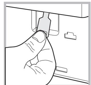
4. trek het lipje dat wordt aangegeven in de afbeelding naar voren totdat het plastic bandje loskomt; trek hem daarna naar beneden en open tegelijkertijd de deur.
