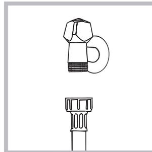
1. Conectar el tubo de tubo enroscándolo a un grifo de agua fría con la boca roscada de 3/4 gas (ver la figura). Antes de conectarlo, haga correr el agua hasta que esté límpida.
