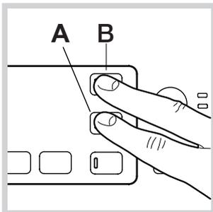
Para activar el programa pulse simultáneamente los botones **A** y **B** durante 5 segundos (ver la figura). El programa comenzará automáticamente y tendrá una duración de 70 minutos aproximadamente.
