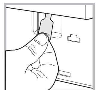
4. Befreien Sie mithilfe der auf der *Abbildung* veranschaulichten Zunge (nach vorne ziehen) die Kunststoff-Spannvorrichtung aus der Arretierung; ziehen Sie letztere dann nach unten und öffnen Sie gleichzeitig die Gerätetür.
