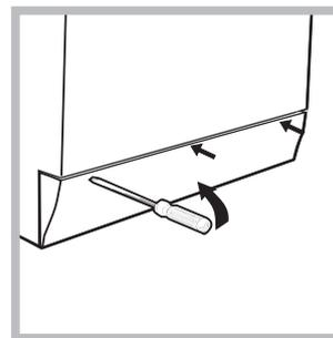
3. verwijder het afdepaneel aan de voorkant van de wasdroogmachine met behulp van een schroevendraaier (zie afbeelding).
