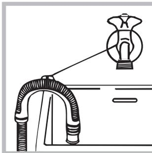
o apóyelo en el borde de un lavamanos o de una bañera, uniendo la guía suministrada con el aparato, al grifo (ver la figura). El extremo libre del tubo de desagüe no debe permanecer sumergido en el
