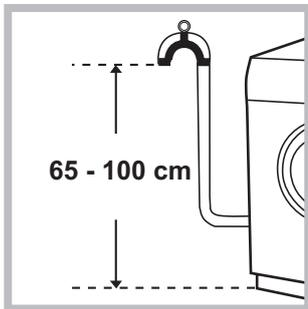
Verbind de buīs, zonder hem te buigen, aan een afvoerleiding of aan een afvoer in de muur tussen de 65 en 100 cm van de grond af;
