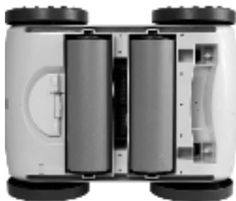
8.1: Draai handmatig de groene rollen. Ze moeten gemakkelijk draaien. Als het vuil de rotatie blokkeert, verwijder dan het vuil.
