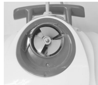
7.3: Klik de klep terug na het reinigen
