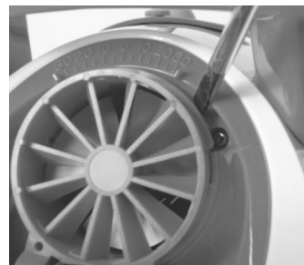
7.2: Gebruik een platte schroevendraaier om de klep montage uitelkaar te halen zoals getoond
