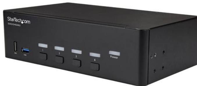
Este conmutador KVM HDMI con 4 puertos le permite controlar cuatro ordenadores equipados con HDMI, mediante un solo ratón, teclado y monitor de hasta 4K a 30Hz. El conmutador KVM también incluye audio con entrada de 3,5mm y un concentrador integrado de 2 puertos USB 3.0.
