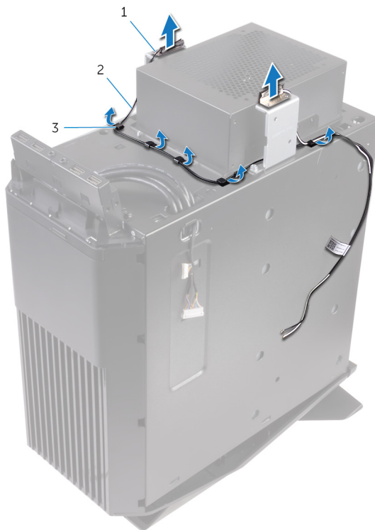
Figure 36. Retrait des câbles d'antenne
