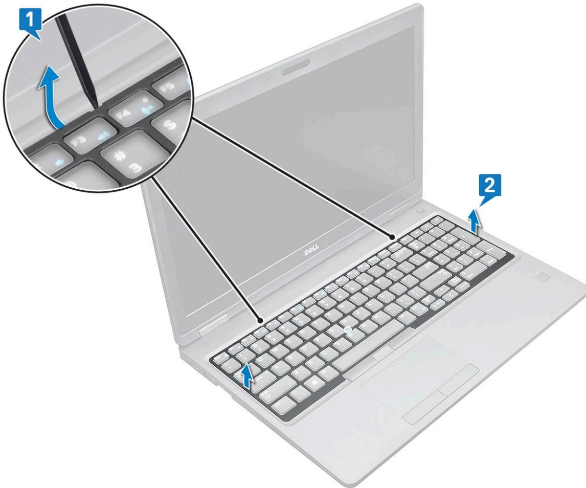
**ANMERKUNG:** Hebeln Sie das Tastaturgitter mithilfe eines Kunststoffstifts an den Hebelpunkten ab und arbeiten Sie sich um das Gitter herum, um es zu entfernen.
