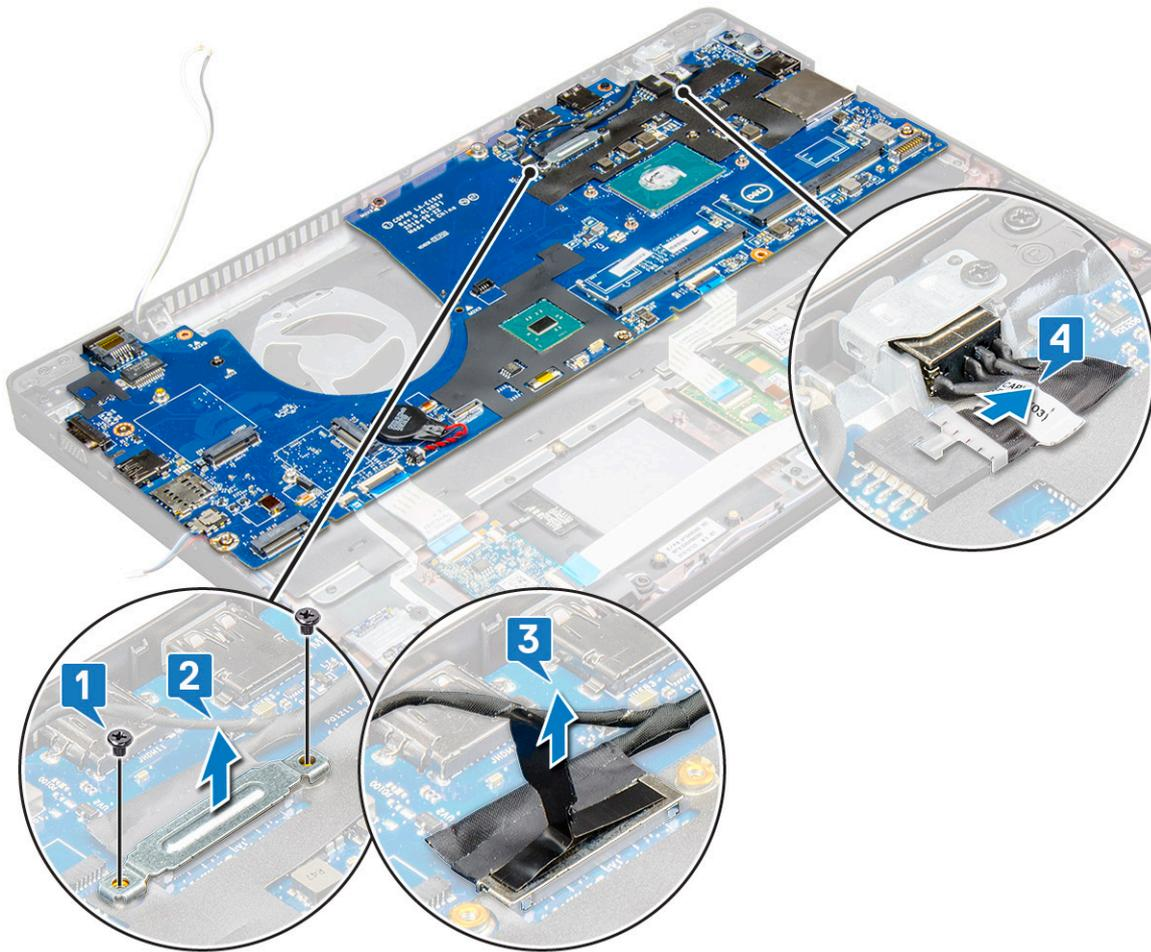
4 So entfernen Sie die Systemplatine:
