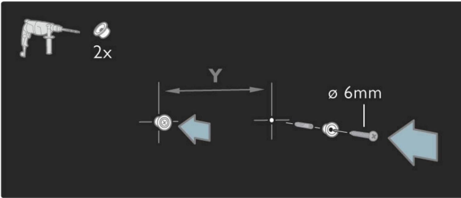
Schieben Sie die Bodenplatte der Halterung auf die Befestigungsscheiben.
