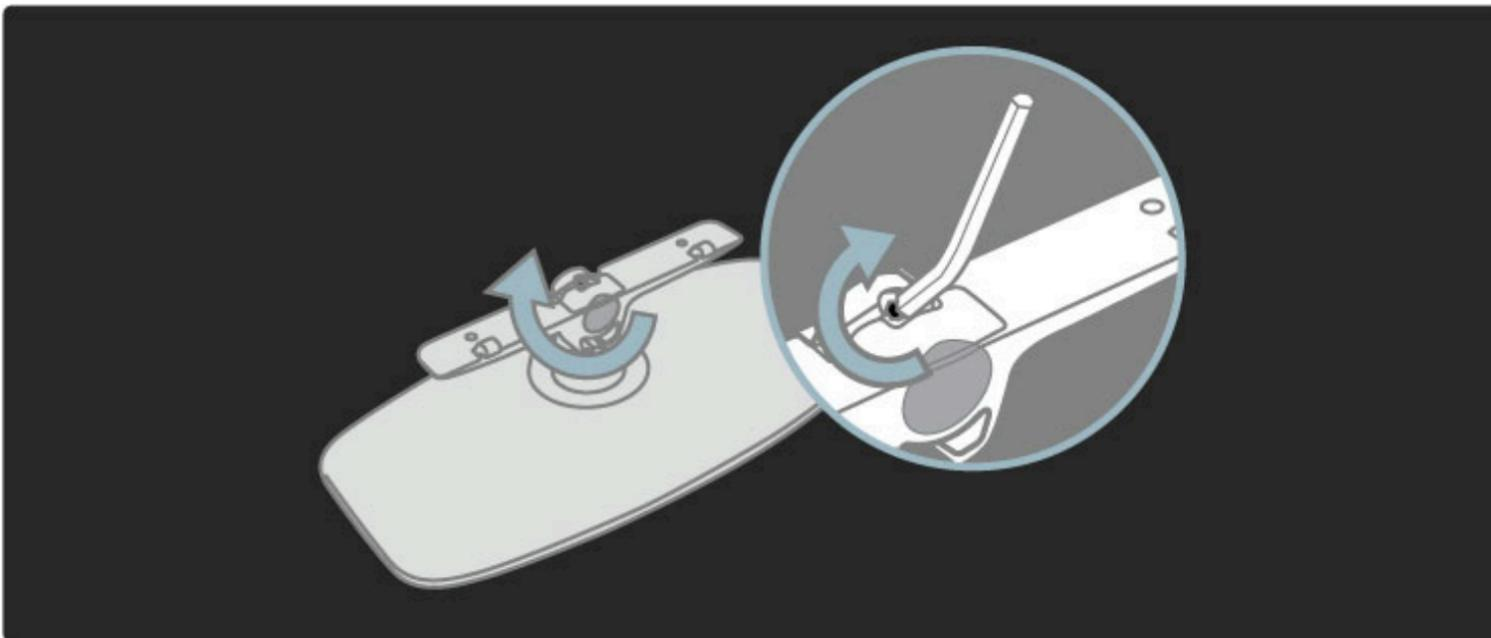
Befestigen Sie den Standfuß am Fernsehgerät.
