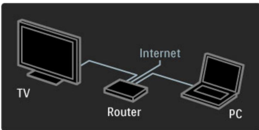
Wenn Sie eine kabelgebundene Verbindung zum Router herstellen möchten, benötigen Sie ein Netzwerkkabel (Ethernet).
