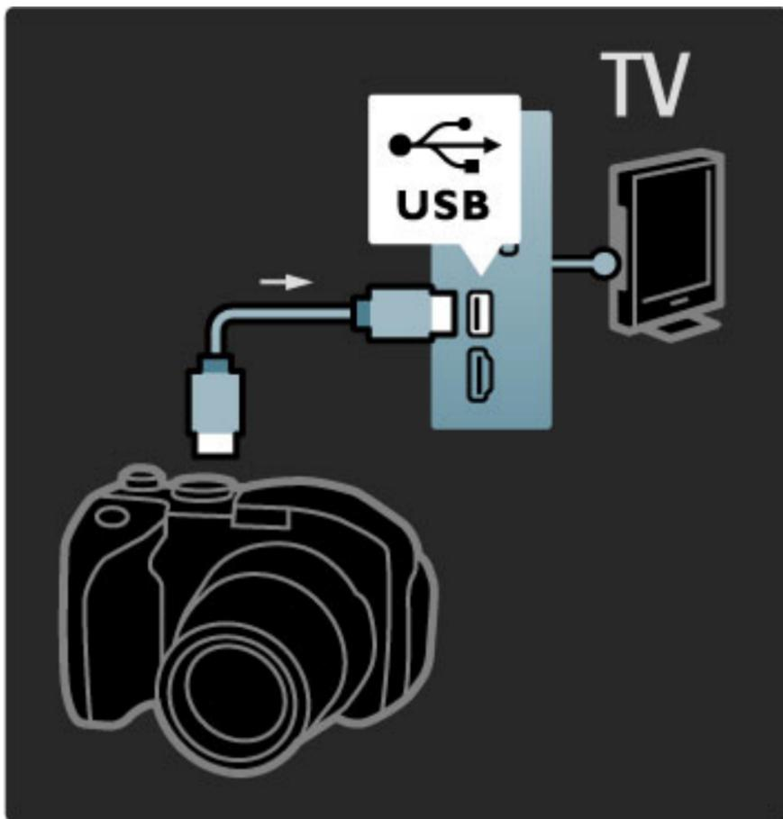
Wenn die Inhalte auf der Kamera nicht automatisch angezeigt werden, muss an Ihrer Kamera unter Umständen die Inhaltsübertragung über PTP (Picture Transfer Protocol) eingestellt werden. Weitere Informationen finden Sie in der Bedienungsanleitung Ihrer Digitalkamera.
