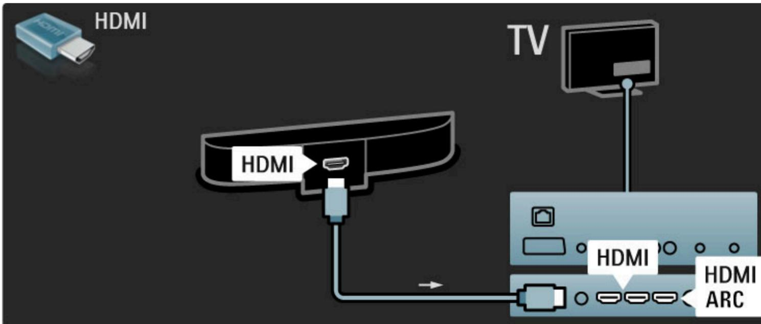
Wenn Sie die HDMI-ARC-Anschlüsse sowohl am Fernsehgerät als auch am Gerät verwenden, benötigen Sie kein weiteres Kabel. Falls nicht, lesen Sie weiter.
