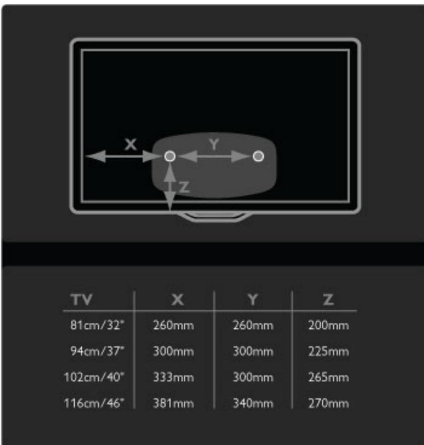
Befestigen Sie die 2 Montagescheiben. Verwenden Sie Schrauben mit einem Durchmesser von max. 6 mm.
