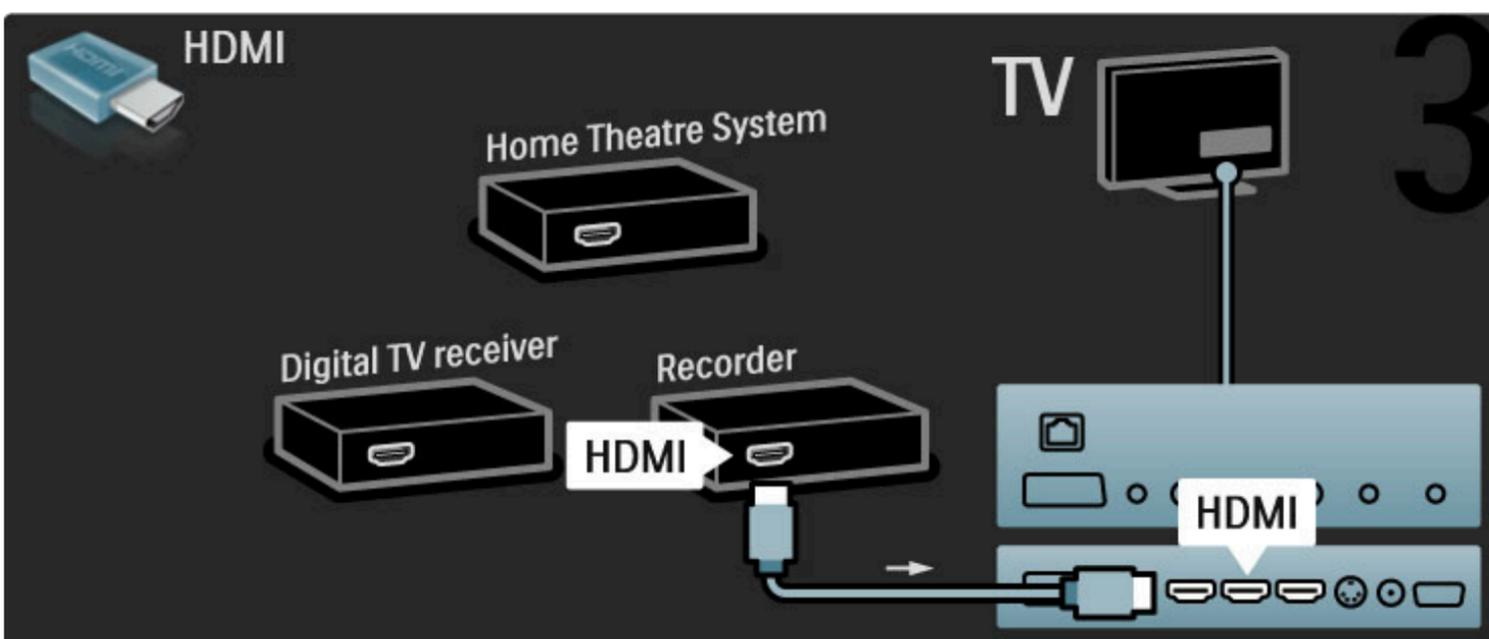
Verbinden Sie dann über ein HDMI-Kabel das Home Entertainment-System mit dem Fernsehgerät.
