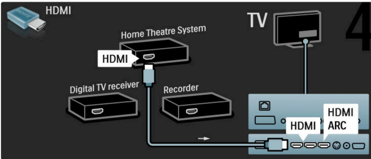
Wenn Sie die HDMI-ARC-Anschlüsse am Fernsehgerät und am Gerät nicht nutzen, fügen Sie ein digitales Audiokabel hinzu (Cinch/Koaxial).
