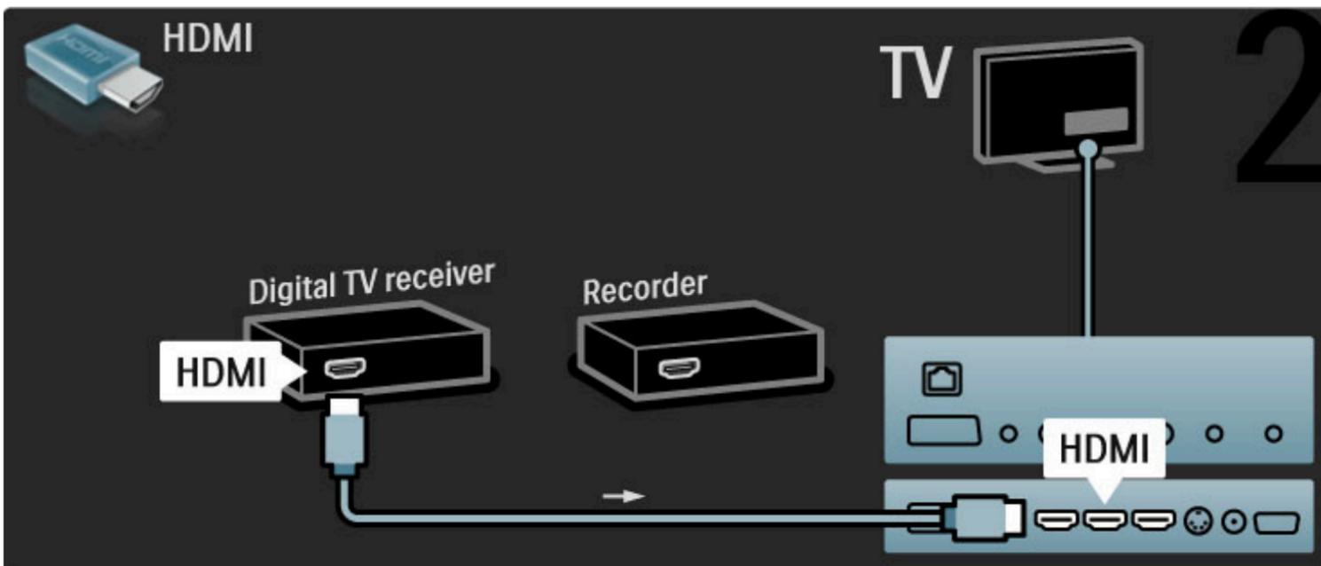
Verbinden Sie schließlich den Disc-Recorder über ein HDMI-Kabel mit dem Fernsehgerät.
