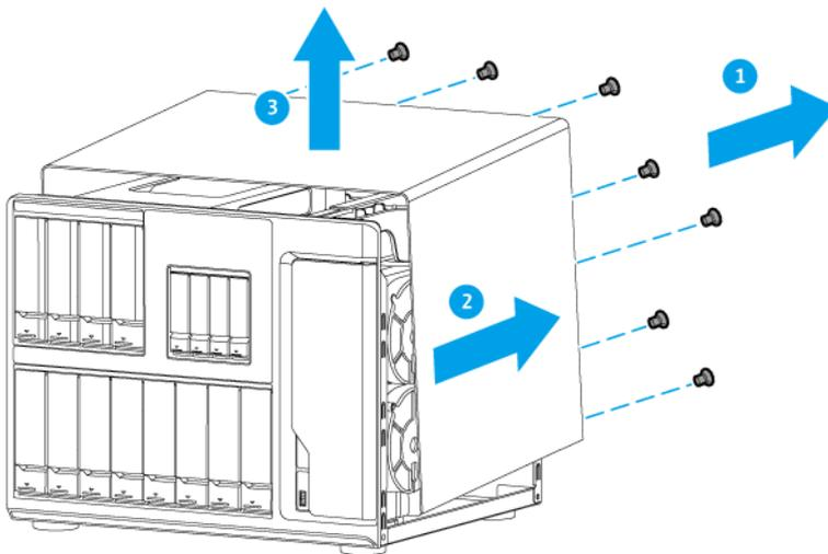
5. Entfernen Sie das Lüftermodul.
