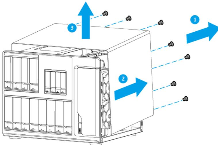
6. Entfernen Sie die PCIe-Abdeckung.
