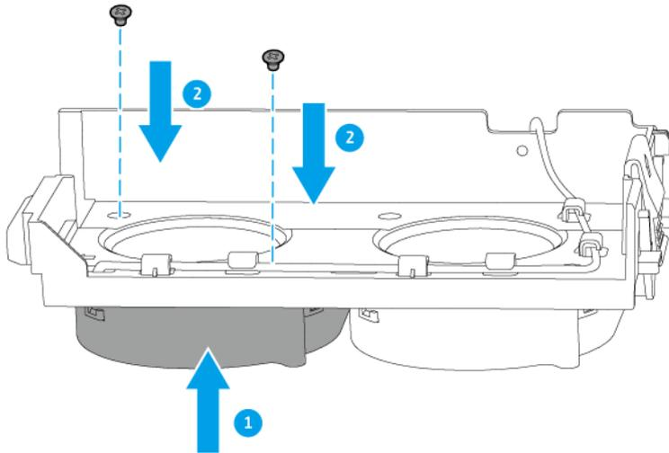
d. Bringen Sie das Lüfterkabel an den Clips am Lüftergehäuse an.
