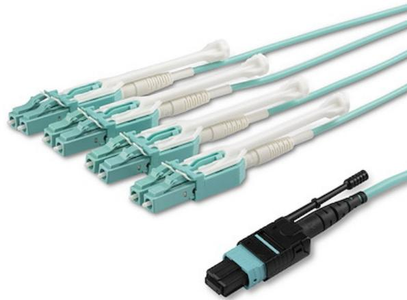
Este cable multiconector MPO/MTP a 4x LC le permite ampliar una única conexión de 40 Gbps desde un transceptor QSFP+ 40GBase-SR4 a cuatro transceptores LC SFP+ 10 Gbps.
