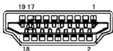
19-stykowy przewód sygnałowy kolorowego wyświetlacza
