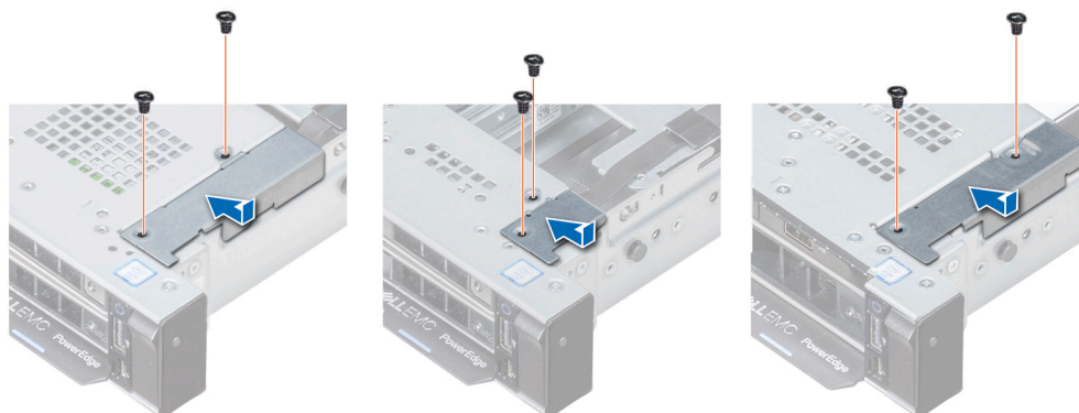
Figura 119. Instalación de la cubierta de cables
