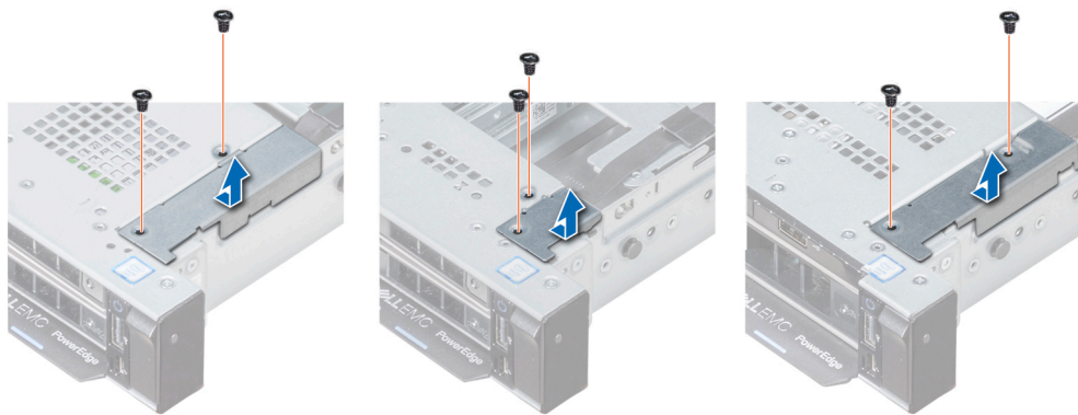
Figura 116. Extracción de la cubierta de cables
