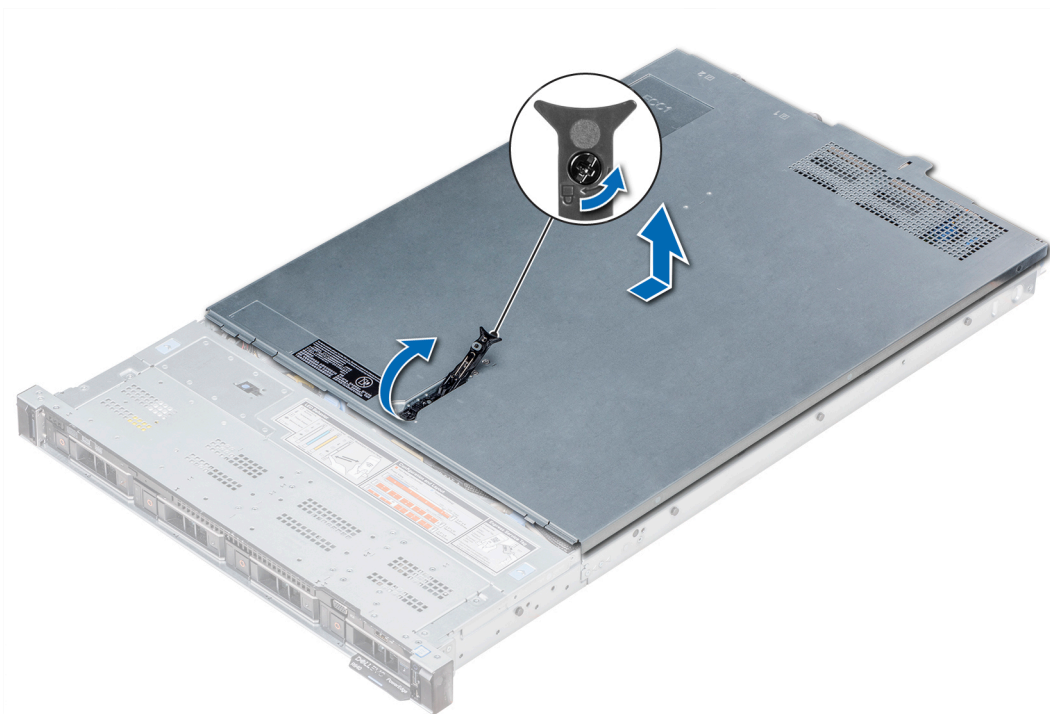
Figura 22. Extracción de la cubierta del sistema
