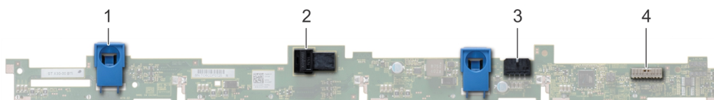
Figura 79. Backplane de la unidad de 4 x 3,5
