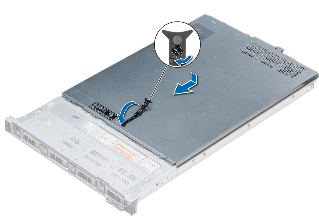
Figura 23. Instalación de la cubierta del sistema
