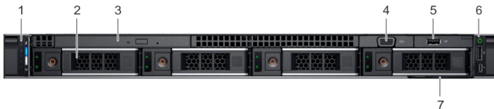
Figura 3. Vista frontal del sistema de la unidad de disco de 4 x 3.5 pulgadas
