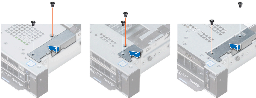
Figure 131. Installation du cache-câbles
