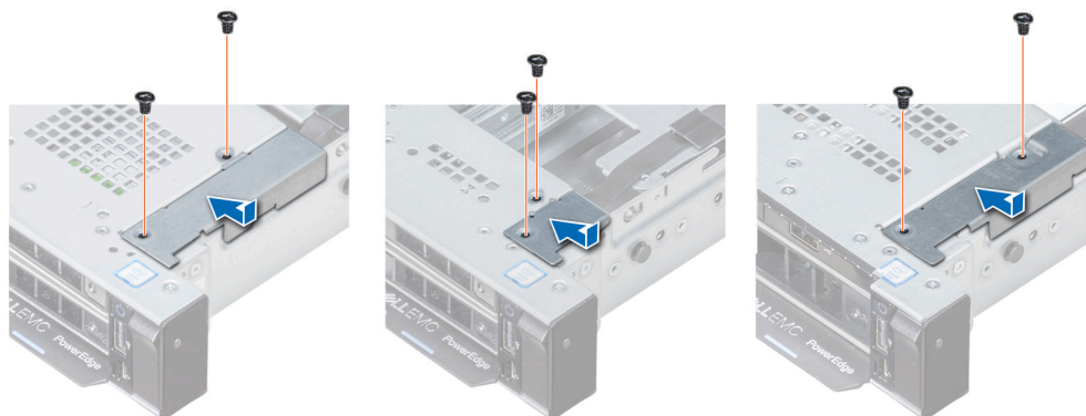
Figure 119. Installation du cache-câbles
