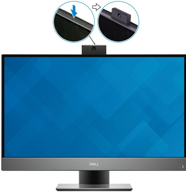
**REMARQUE :** Faites sortir la caméra en utilisant n'importe quelle fonction de la caméra afin qu'elle ne se bloque pas.
