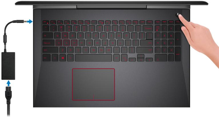
**ANMERKUNG:** Um Energie zu sparen, wechselt der Akku möglicherweise in den Energiesparmodus. Schließen Sie den Netzadapter an und drücken Sie den Betriebsschalter, um den Computer einzuschalten.
