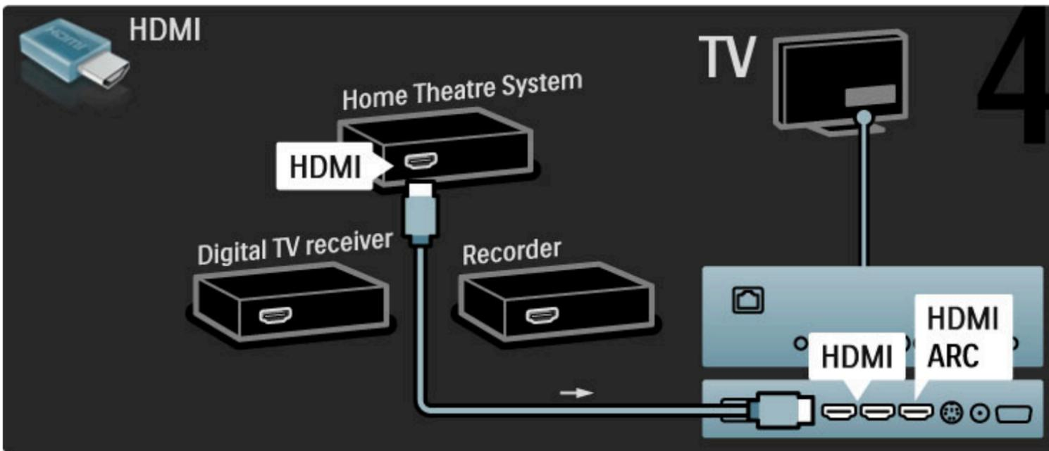
Si vous n'utilisez pas les prises HDMI-ARC du téléviseur et de l'appareil, ajoutez un câble audio numérique (cinch coaxial).
