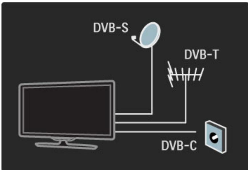
Oltre alla ricezione DVB-T e DVB-C, questo televisore dispone di ricevitore DVB-S integrato. È possibile collegare un'antenna satellitare e ricevere i **canali satellitari digitali**.
