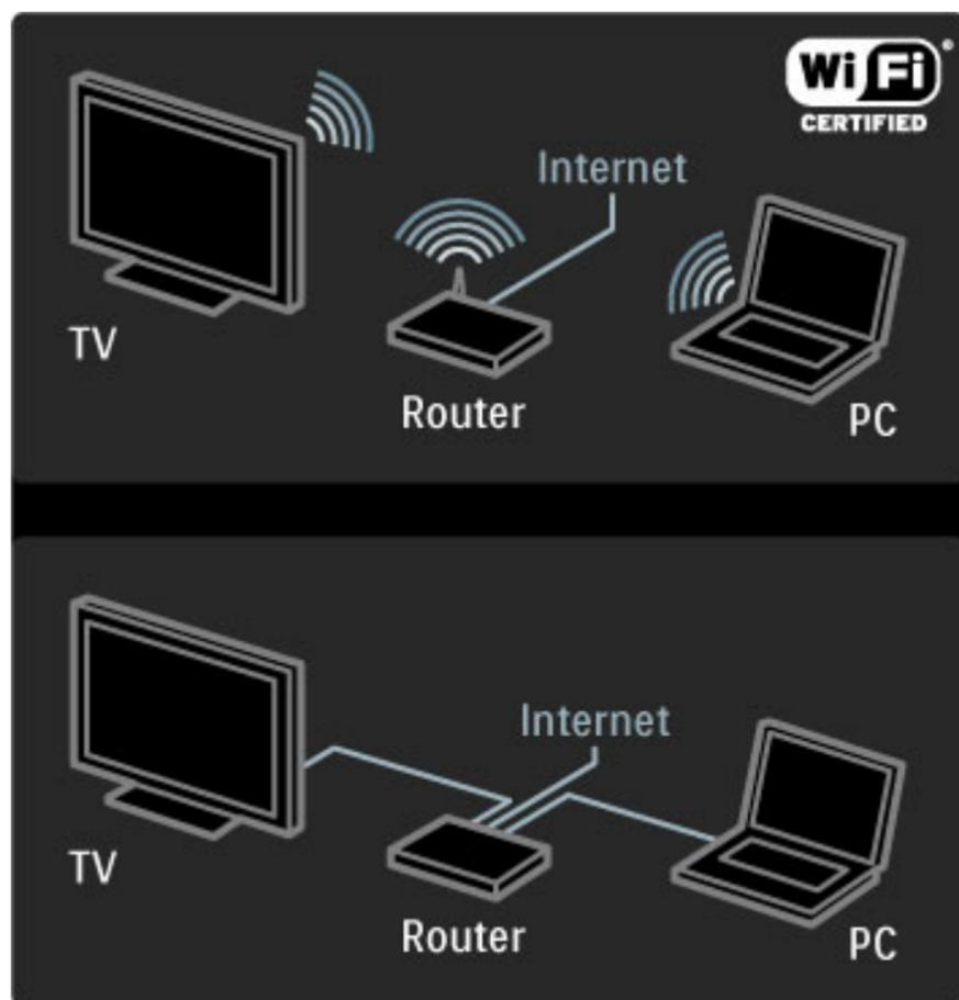
Per la connessione cablata al router è necessario un cavo di rete (Ethernet).
