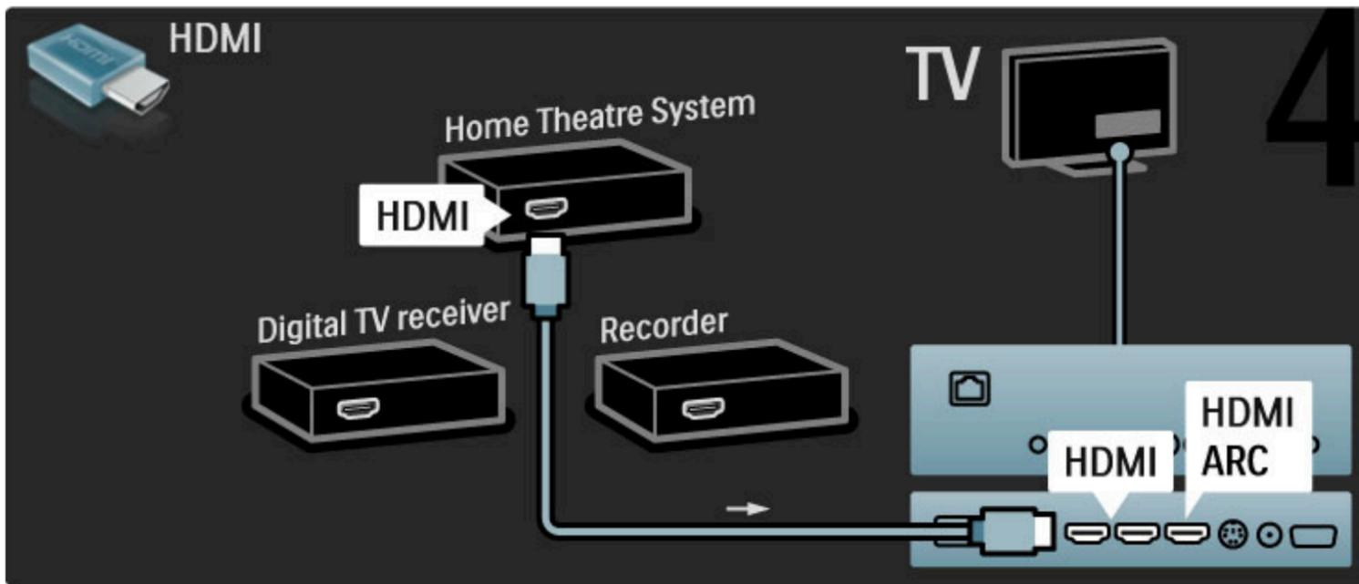
Se non si utilizza il collegamento HDMI-ARC sul televisore e il dispositivo, aggiungere un cavo audio digitale (coassiale cinch).
