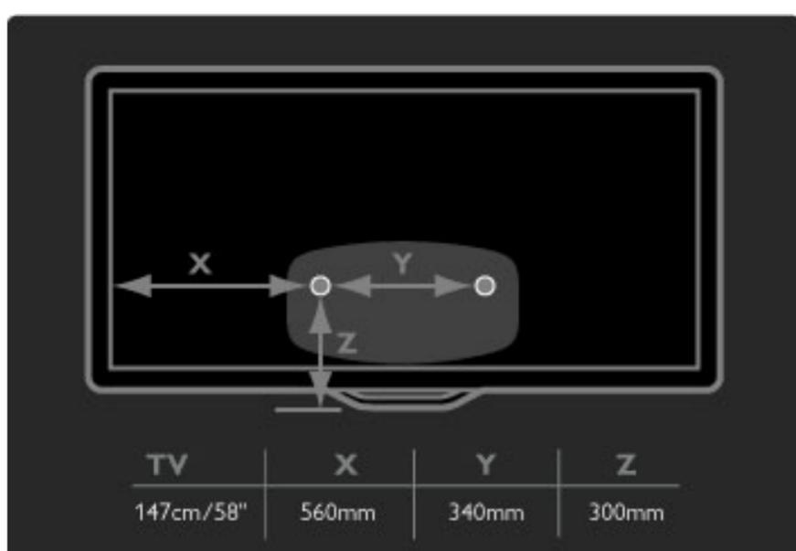
Fissare i 2 dischi di montaggio. Utilizzare viti con diametro massimo di 6 mm.
