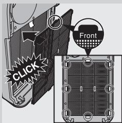
**5** 将预过滤网放回产品内部。然后将所有挂钩正确连接到产品上。
