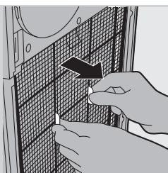
**2** 要卸下预过滤网，请抓住两个凸缘，然后朝您自己的方向拉动过滤网。
