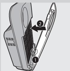
**8** 要装回前面板, 请首先将底部的挂钩插到产品底部 (1)。然后, 朝产品机身方向推动面板 (2)。
