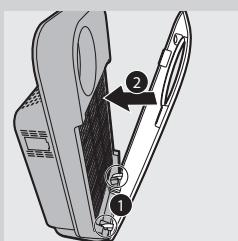
**6** 要装回前面板，请首先将底部的挂钩插到产品底部 (1)。然后，朝产品机身方向推动面板 (2)。
