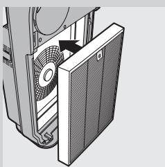
**4** 将过滤网 2 ( 纳米级劲护滤网 ) 放入产品中。
