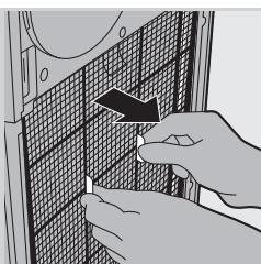
**3** 要卸下预过滤网，请抓住两个凸缘，然后朝您自己的方向拉动过滤网
