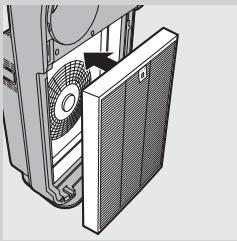
**6** 将过滤网 2 ( 纳米级劲护滤网 ) 放回产品中。
