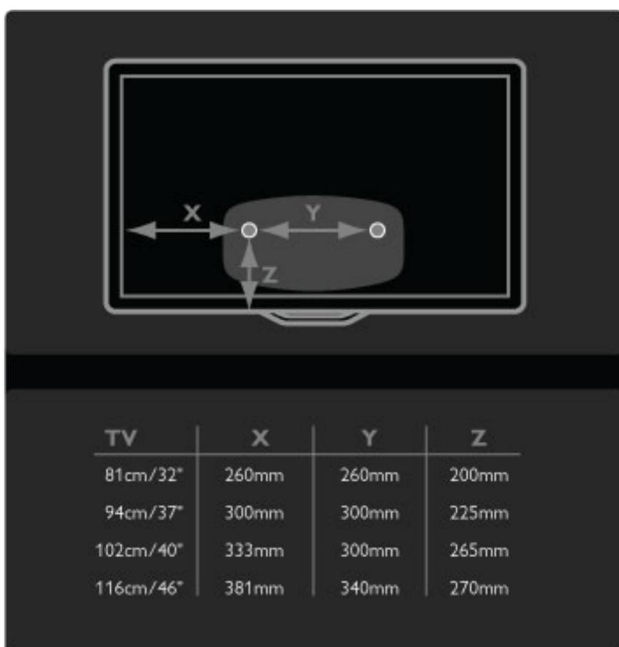
Fissare i 2 dischi di montaggio. Utilizzare viti con diametro massimo di 6 mm.
