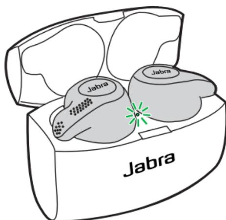
Sono necessarie circa due ore per caricare completamente gli auricolari. Se la batteria degli auricolari è quasi scarica, puoi ottenere fino a un'ora di tempo di riproduzione musicale se li posizioni nella custodia di ricarica per 10-20 minuti.
