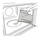
Une fois que le four est froid seulement, remplissez le gaufrage de la cavité avec la quantité d'eau potable suggérée dans le tableau de cuisson correspondant.
