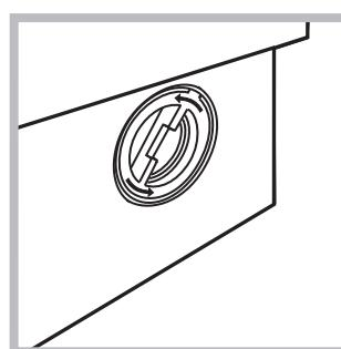
2. odkręcić pokrywę, obracając ją w kierunku przeciwnym do ruchu wskazówek zegara (patrz rysunek); wypłynięcie niewielkiej ilości wody jest normalnym zjawiskiem;
