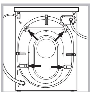
3. Csavarozza ki a készülék hátsó részén található, a szállításhoz szükséges 4 védőcsavart, és távolítsa el a gumibakot a távtartójával együtt (lásd ábra).
