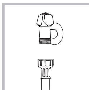
1. Pripojte prívodnú hadicu jej zaskrutkováním ku kohútiku so studenou vodou, s hrndlom so závitom 3/4" (vid' obrázok). Pred pripojením hadice nechajte vodu odtieť, až kým nebudete číra.
