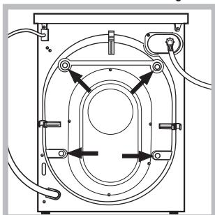
3. Odkręcić 4 śruby zabezpieczające urządzenie na czas transportu oraz zdjąć gumowy element z podkładką, znajdujący się w tylnej części pralki (patrz rysunek).
