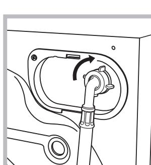
2. A vízbevezető cső csatlakoztatásához csavarozza a csövet a mosogép hátoldalán jobbra fent található vízbemeneti csonakra (lásd ábra).
