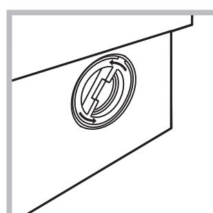
2. Odskrutkujte veko otáčaním proti smeru hodinových ručičiek (*vid' obrázok*): výtečenie malého množstva vody je úplne bežným javom;
