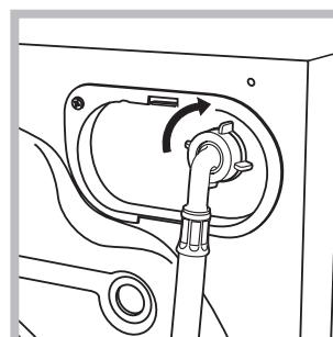
1. Podłącz przewód zasilający poprzez przykrecenie go do zaworu zimnej wody z końcówką gwintowaną (patrz rysunek): Przed podłączeniem spuszczać wodę do momentu, aż stanie się ona całkowicie
