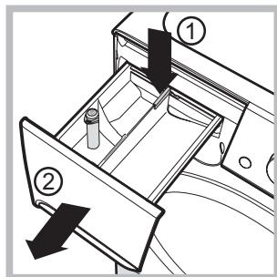
Para extraír a gaveta, pressione a lingueta (1) e puxe para fora (2) (veja a figura). Lave-a com água corrente; esta limpeza deve ser efectuada frequentemente.
