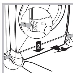
1. Odložte krycí panel na prednej strane zariadenia zatlačením na jeho stred a následným zatlačením smerom nadol z obidvoch strán a potom ho vytiahnite (*vid' obrázky*).
