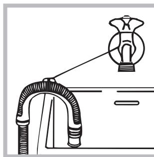
ou coloque na beira de um lavabo ou de uma banheira, prenda na torneira a guia fornecida (veja a figura). A ponta solta do tubo de descarga não deve permanecer emergida na água.
