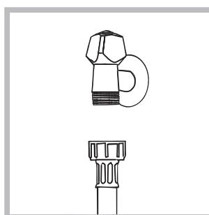
1. A vízbevezető cső csatlakoztatásához csavarozza fel a csövet egy 3/4"-os külső menettel rendelkező hidegvízcsapra (lásd ábra). A csatlakoztatás előtt eressze meg a csapot, és folyassa a vizet addig, amíg az teljesen átlátszóvá nem válik!
