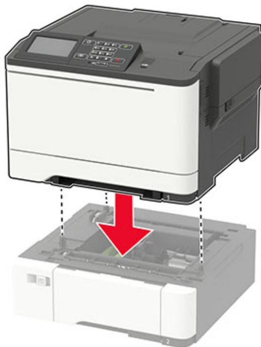
**Nota:** Si va a instalar las dos bandejas opcionales, coloque la bandeja de 550 hojas bajo la bandeja dúplex de 650 hojas.
